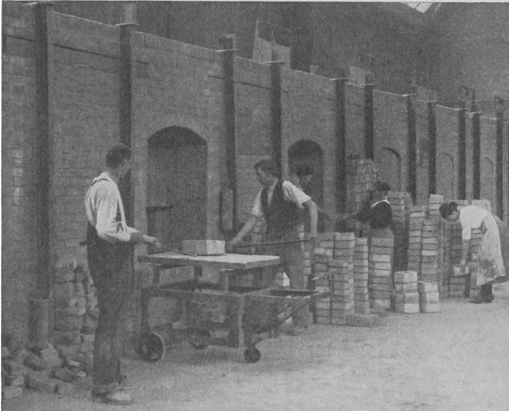
Abb. 10. Kühlöfen. Links das Einlegen der aus dem Senkofen kommenden Formen mit dem „gesenkten“ Glas. Rechts: Entleeren eines Ofens.
