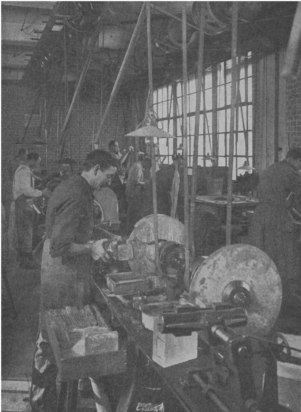
Abb. 14. Glasschneiderei. Die vom Lager kommenden Glasplatten werden mittelst Diamantsägen in Streifen zerlegt.
