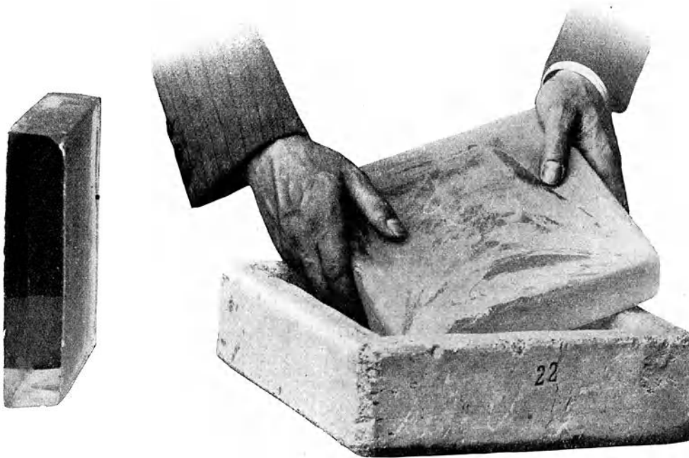
Abb. 11. Form mit gesenkter Glasplatte, wie sie aus dem Kühllofen kommt. Die Oberflächen sind undurchsichtig. Links: an zwei gegenüberliegenden Seiten anpolierte Senkplatte.
