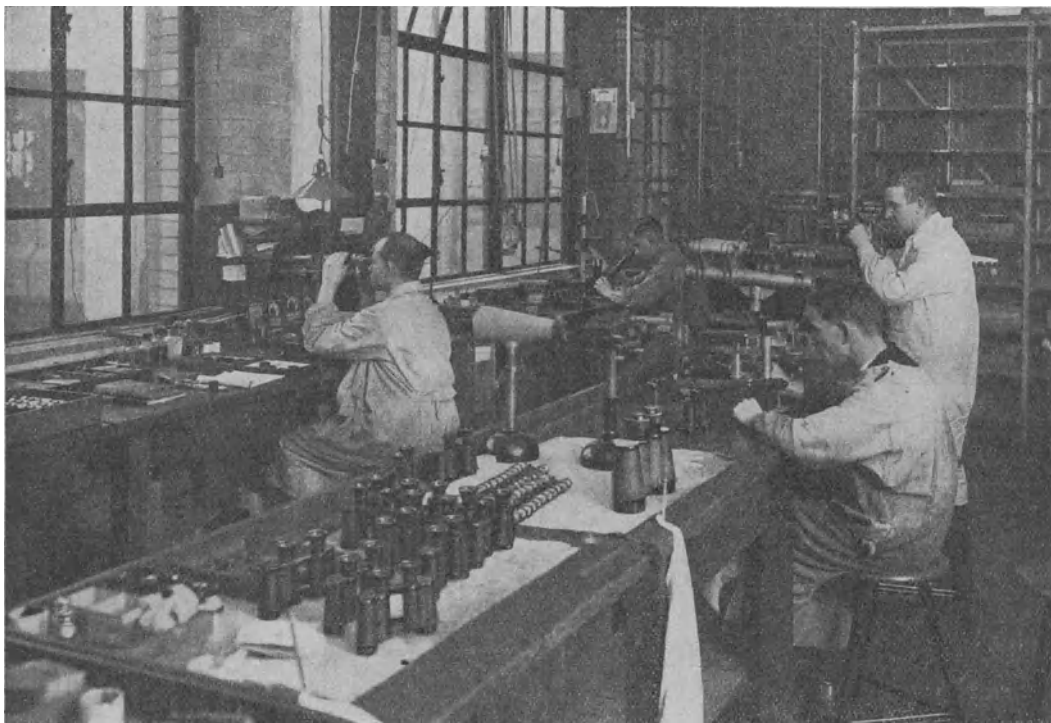
Abb. 25. Prüfzimmer des Doppelfernrohrbaues. Hier wird die letzte Prüfung der fertigen Fernrohre vorgenommen. Vor allen Dingen werden die Instrumente auf Gesichtsfeld, Parallelität der Achsen, Vergrößerung und Austrittspupille (Helligkeit) geprüft.
