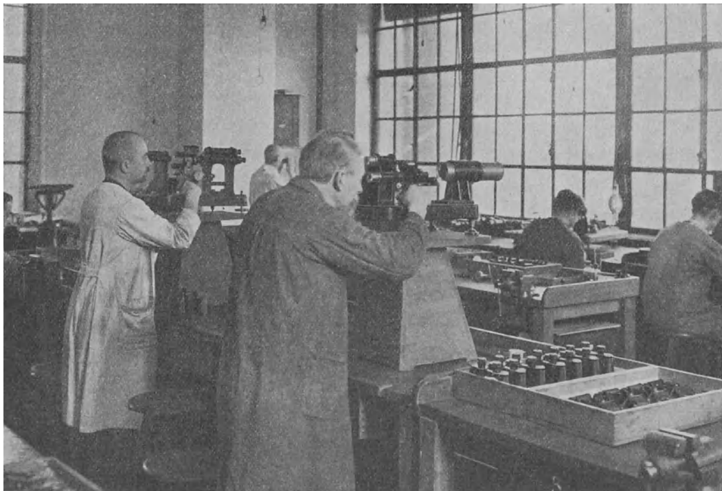
Abb. 24. Fernrohr-Justiererei. An den beiden im Vordergrund abgebildeten Instrumenten werden die optischen Achsen der Einzelfernrohre eines Doppelfernrohres parallel gerichtet.
