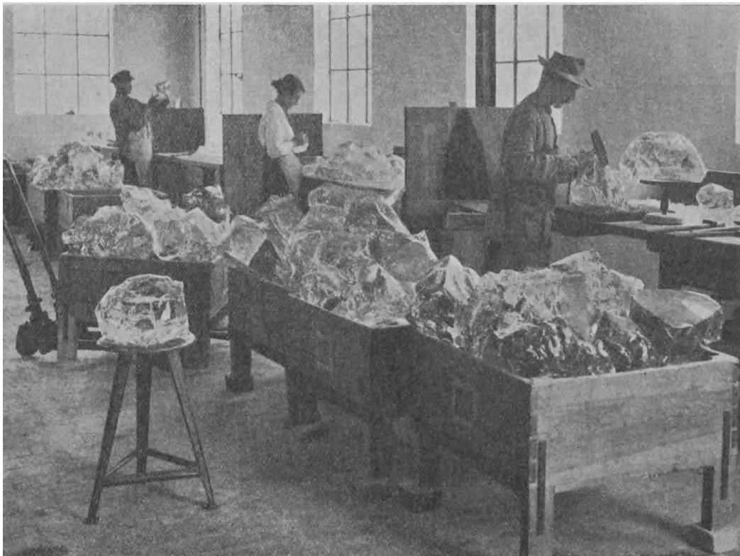
Abb. 8. Das Sortieren der Hafenglasbrocken. Mittels eines Hammers werden scharfe Kanten, Einsprünge usw. entfernt, oder der Brocken zerlegt.
