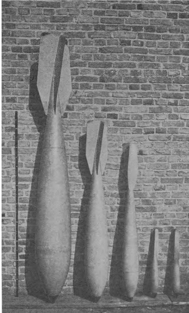
Abb. 42. Moderne Fliegerbomben von 12 bis 300 kg Gesamtgewicht und 75 bis 275 cm Länge.
