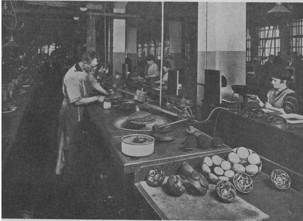
Abb. 16. Poliererei. Auf „Köpfen“ (im Vordergrund) werden die Linsen mit Siegelack aufgekittet (rechts) und dann unter fortwährender Beigabe von Wasser und feinem Schmirgel bzw. Polierrot feingeschliffen und poliert.
