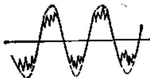
**Рнс. 6.5. Искажения сигнала при узкой полосе пропускания тракта ПЧ**
