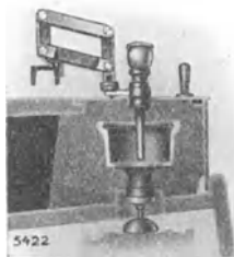
Abb. 60. Spinntrichterhalter (in Arbeitsstellung).
