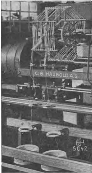
Abb. 76. Haspelaggregat für Zentrifugenseide. System C. G. Haubold A.-G.
