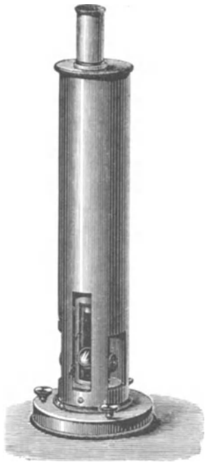
Fig. 2. Instrument zur Beobachtung correspondirender Sonnenhöhen.
