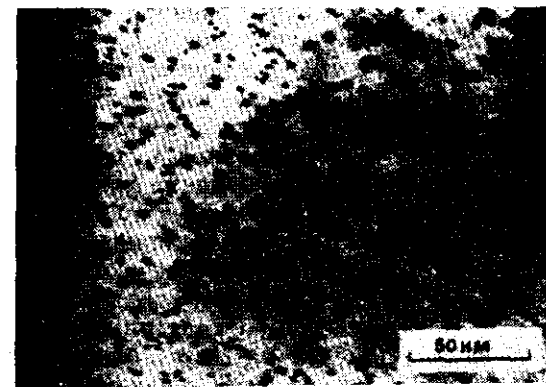
Рис. 18. Электронно-микроскопический снимок ультратонкой пленки платины, напыленной при 545 К в СВВ на расщепленную на воздухе слюду. Средний вес пленки на единицу поверхности 1,2 \cdot 10^{-3} г/м 2 .
