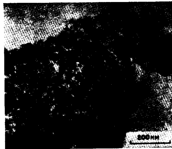
Рис. 4. Электронно-микроскопический снимок тонкого среза катализатора 2,5% \text{Pt}/\text{SiO}_2 , полученного пропиткой \text{H}_2\text{PtCl}_6 силикагеля дэвисон 70 и восстановленного \text{H}_2 при 480 К. Черные точки — частицы платины [40].
