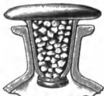
Abb. 183. Mit Ätzkalk gefüllter Glasstopfen für Pulverflaschen.
