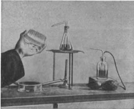
Abb. 100. Abdämpfen der Ampullenhäuse vor dem Zuschmelzen.
