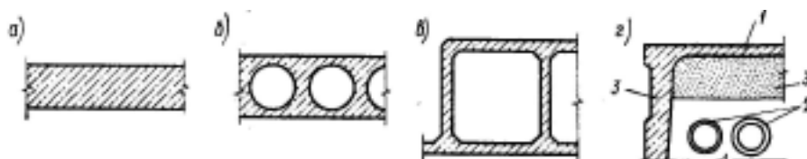
Рис. XIV.2. Типы сборных плит междуэтажных перекрытий:
