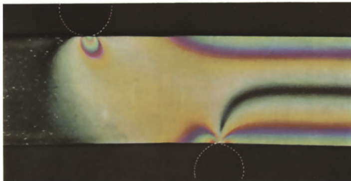
Abb. 147. Farbgleichen in einem Zelluloidstab zwischen vier Lasten nach Abb. 142 und 143.
