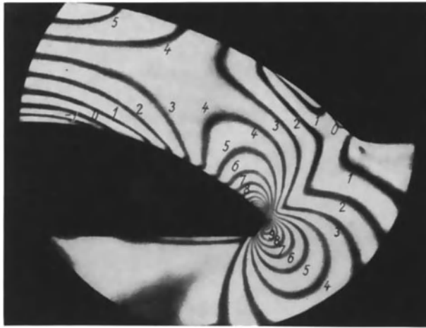
Abb. 173a und b. Modell eines waagerechten Schnittes einer beiderseits eingemauerten gebogenen Staumauer unter der Wirkung äußeren Wasserdrucks. a) Hauptlinien; b) Farbgleichen.
