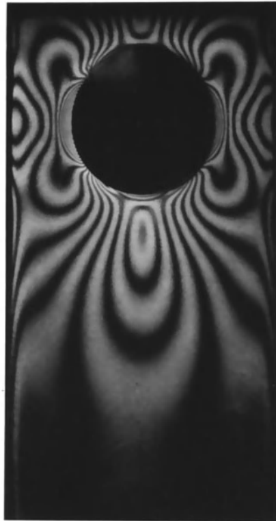
Abb. 162. Farbgleichen im Zugstab mit Mittelloch, a = 0,53 b .
