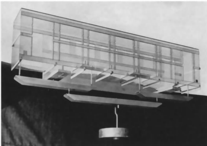
Abb. 196. Räumliches Modell eines Eisenbahnwagens aus Zelluloid.
