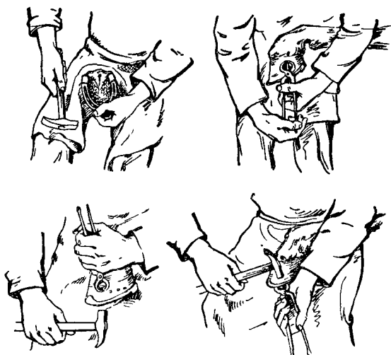
Рис 104. Приемы прикрепления подковы к копыту
