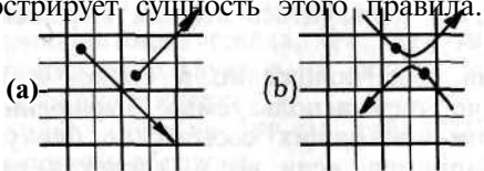
Рис. 12.3. HPP-GAS. (a) Равномерное движение изолированной частицы. (b) Частицы после лобового столкновения разлетаются вдоль другой диагонали.
