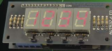
AVT537 - Moduł terminala z wyświetlaczem LED Moduł z wyświetlaczem LED może służyć do wyświetlania wyników pomiarów wykonanych na przykład za pomocą karty wejść analogowych
