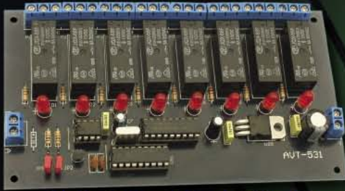
AVT531 - Karta wyjść przekaźnikowych Karta wyjść przekaźnikowych zawiera osiem przekaźników o obciążalności styków 8 A
