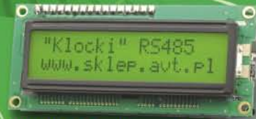
AVT538 - 32-znakowy wyświetlacz LCD Moduł umożliwia wyświetlenie 32 dowolnych znaków przesyłanych w kodzie ASCII poprzez magistralę RS485
