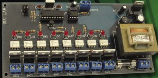
AVT532 - Karta triaków Karta może być zastosowana do sterowania urządzeniami zasilanymi napięciem 230 VAC. Gwarantuje galwaniczną separację od sieci energetycznej
