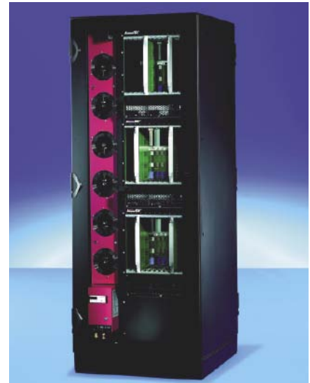
Fot. 6. Koncepcja niezależnego chłodzenia jako kompletne rozwiązanie szafy: Varistar z wodno-powietrznym wymiennikiem ciepła LHX 20
