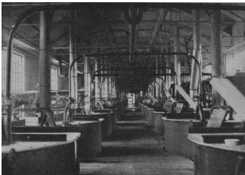
Abb. 5. Anlage zum Stabilisieren von Kollodiumwolle der Deutschen Celluloid-Fabrik Eilenburg.
