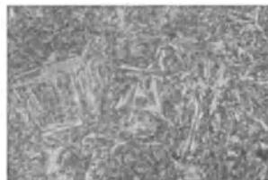
Abb. 13. Stahl mit 1,2% C von 870° abgeschreckt.
