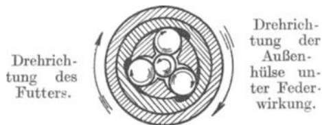
Abb. 127. Selbstspannendes Grönkvist-Bohrfutter, Schnitt.
