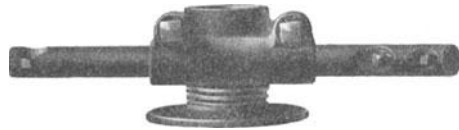
Abb. 50. Bohrstahlhalter, in der Höhe leicht verstellbar.
