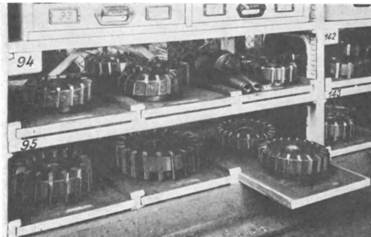
Abb. 10. Schiebebretter in Führungsleisten.
