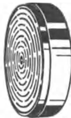
Abb. 137. Elektromagnetisches Rundfutter. Ringpolteilung.
