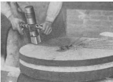
Abb. 94 Scharieren mit FMA-Scharierhammer
