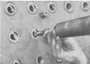
Abb. 56 Durchschlagen mit FMA-Meißelhammer Tabelle 23 Nr. 1—24
