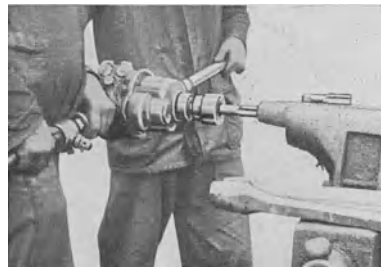
Abb. 63 Gewindeschneiden mit FMA-Bohrmaschine Tabelle 26 Nr. 1—15/31—35
