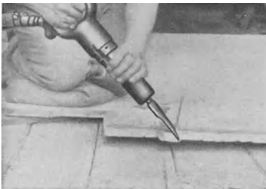
Abb. 70 Kupferschneiden mit FMA-Meißelhammer Tabelle 23 Nr. 15—24
