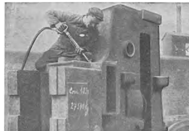
Abb. 77 Gußputzen mit FMA-Meißelhammer Tabelle 23 Nr. 1—24
