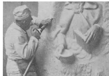
Abb. 95 Bildhauerarbeiten mit FMA-Meißelhammer Tabelle 23 Nr. 17—24
