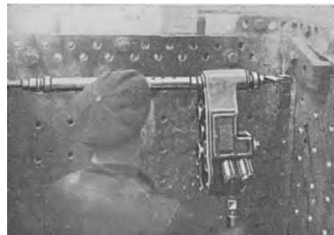
Abb. 65 Bohren mit FMA-Eckenbohrmaschinen Tabelle 26 Nr. 21/22/41—44
