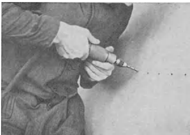
Abb. 68 Bohren mit FMA-Bohrmaschine Tabelle 25 Nr. 61—65
