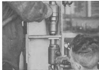
Abb. 45 Spantennieten mit FMA-Eck-Niethammer Tabelle 22 Nr. 17, 51—55
