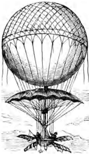
Fig. 117. Blanchard's Luftballon mit Fallvorrichtung.
