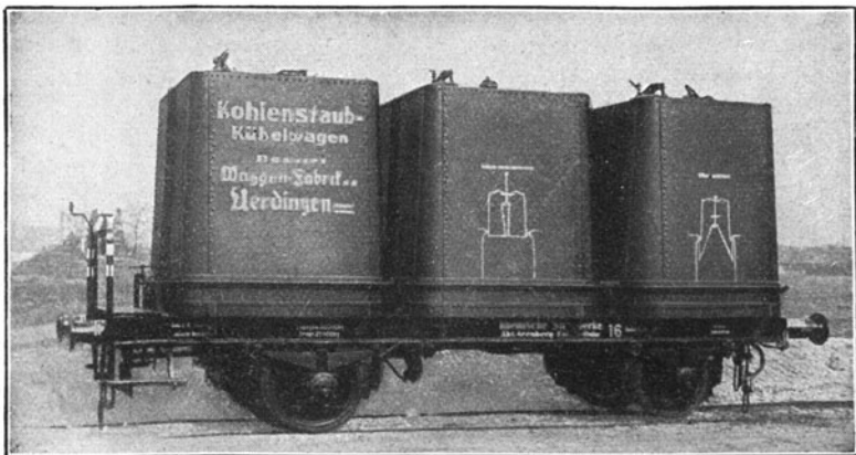
Abb. 102. Kohlenstaub-Kübelwagen. Ladegewicht 3 \times 6 = 18 t, Inhalt 3 \times 9,5 = 28,5 m 3 Eigengewicht 12,5 t. Hersteller: Waggonfabrik A. G., Uerdingen.
