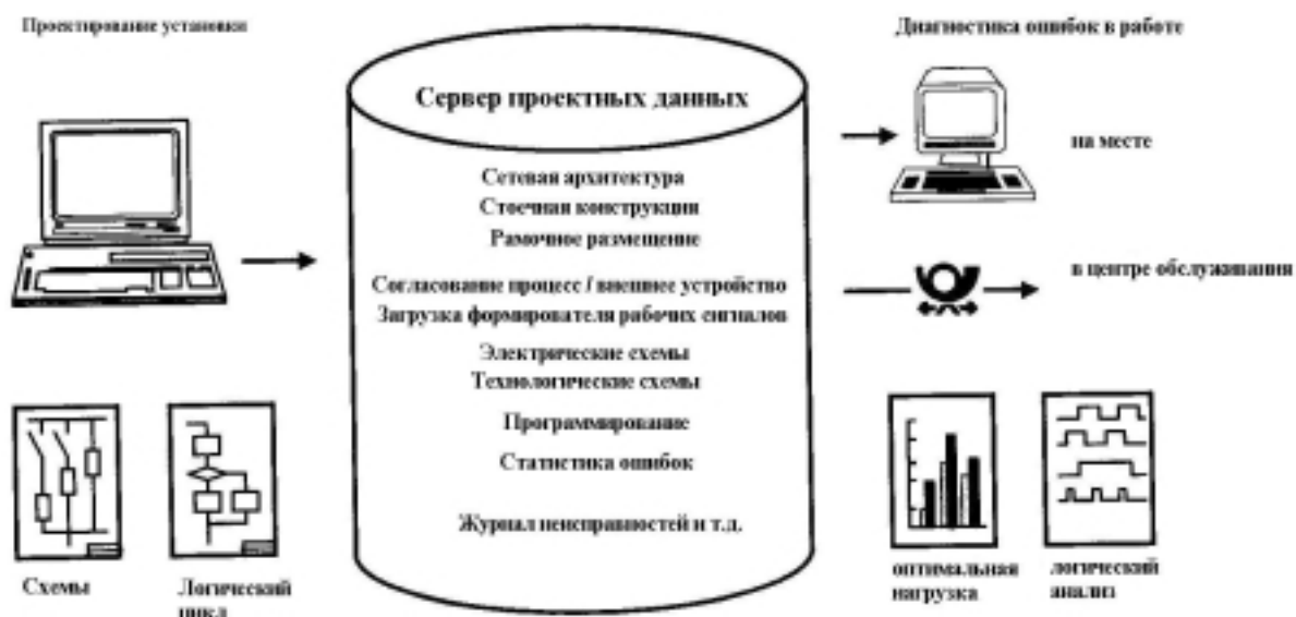
Рис. 11.2 Сервер проектных данных содержит общую документацию системы
