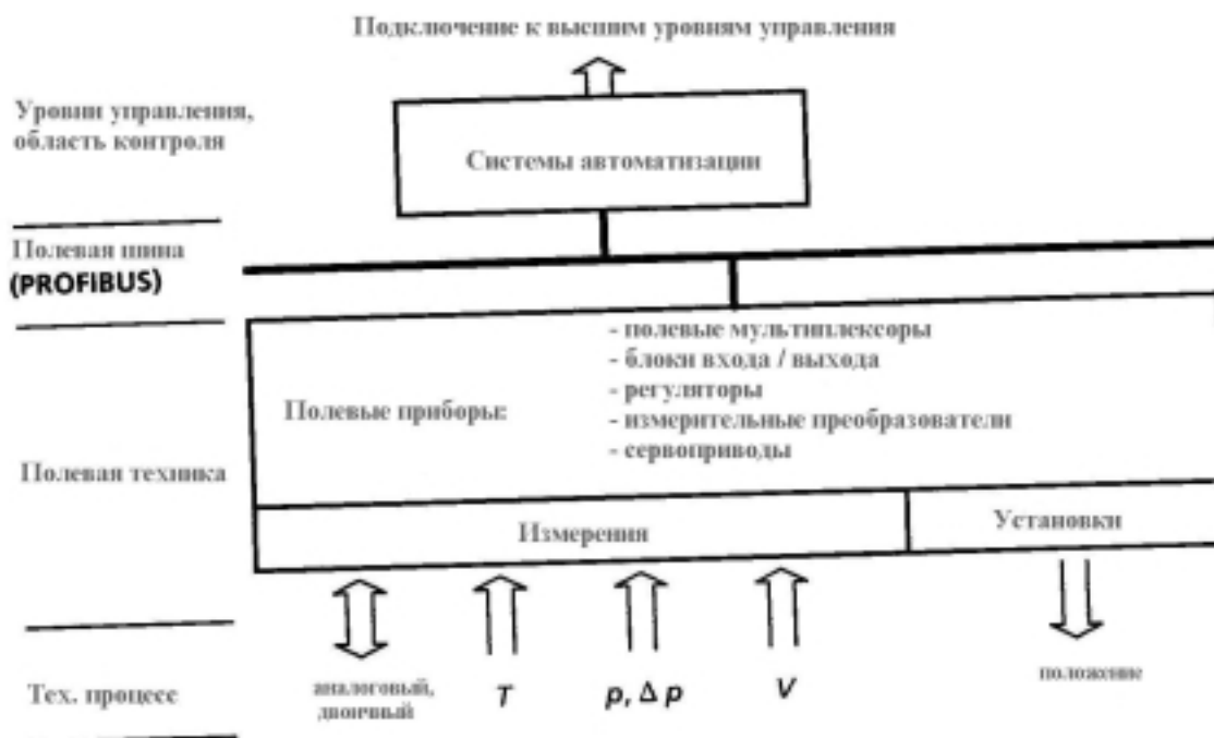
Рис. 10.1 Расположение полевой техники в пирамиде автоматизации
