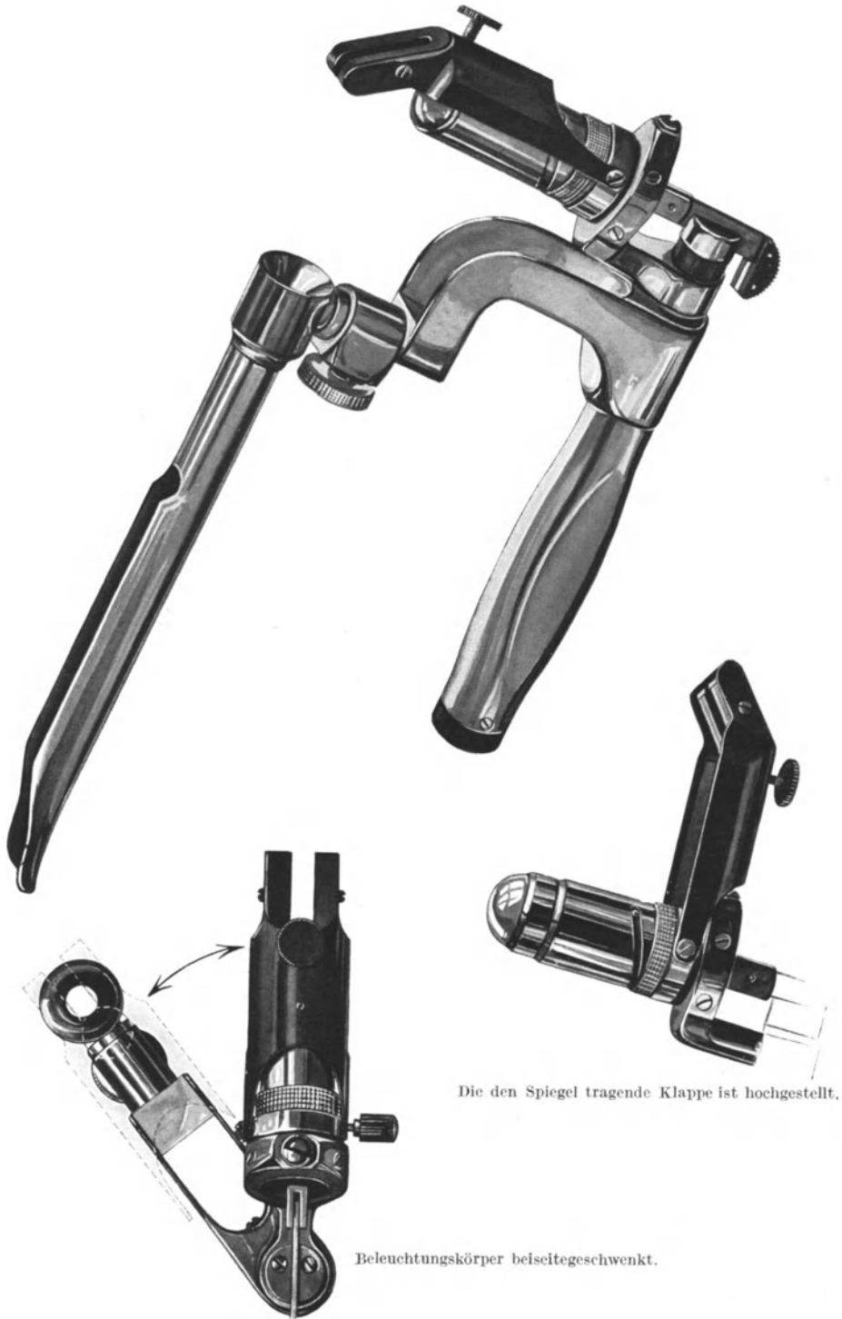
Abb. 11. Elektroskop nach BRÜNINGS
