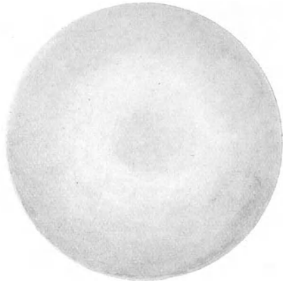
Abb. 299. Stenström. Film, exponiert, während der Zylinder rotiert. Der Film ist unmittelbar unter dem Zylinder angebracht.
