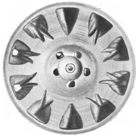
Abb. 297. Stenström. Der Radiumträger mit 15 Zellen für die in 2 Kreisen angeordneten Radiumpräparate von 3 verschiedenen Typen.
