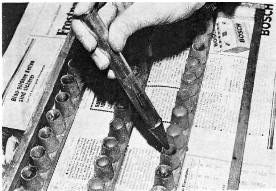
Рис. 51 — Деревянные пробки с выемками заполняют воском
