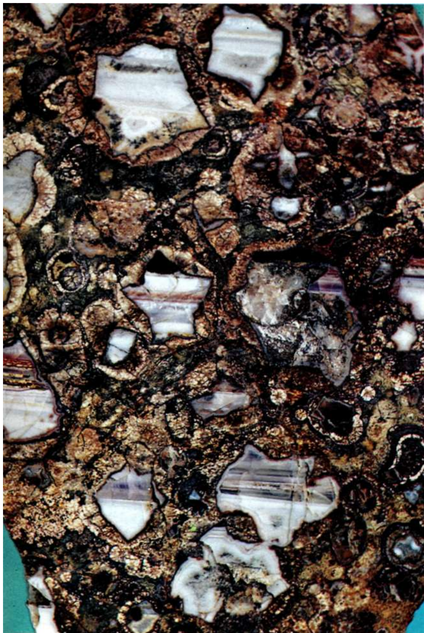
Фото 105. Фельзит с большим числом мелких литофиз, полости которых заполнены агатом, а оболочка имеет отчетливую сферолитовую структуру. Верховье р. Ужбракчан, правобережье р. Колымы. Якутская АССР. ~16,0X10,0 см. № 83229.
