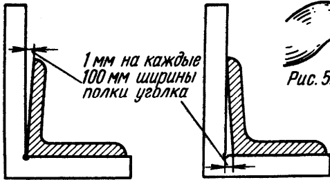
Рис.4. Допускаемые отклонения от прямого угла профиля уголка
