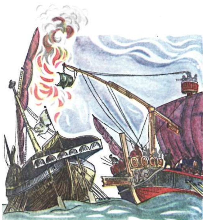
Корабль, вооруженный «греческим огнем», за- жигательной смесью в бочках и горшках. В состав смеси входили сера, смола и нефть. «Греческий огонь» применялся в морских сражениях для поджога кораблей, при осаде и обороне городов, а также в полевых сраже-
