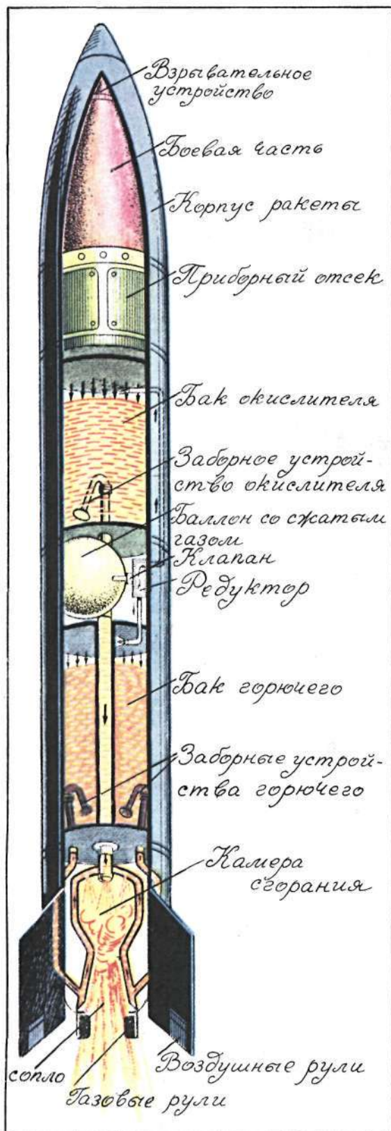
Устройство управляемой баллистической ракеты на жидком топливе.
