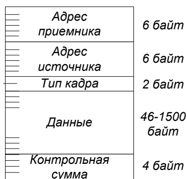
Рис. 6.24. Формат кадра ЛВС Ethernet
