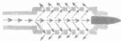
Действие пороховых газов в дульном тормозе.
