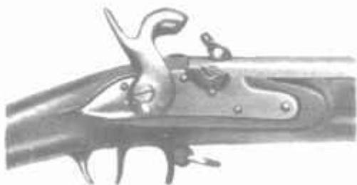
Русское капсюльное ружье. Ударно-капсюльный замок.
