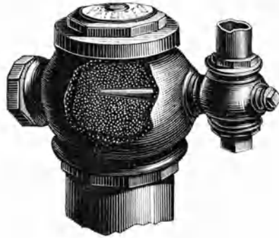
Dampfstrahlgebläse für rauchlose Feuerung der Great Britain Smoke Consuming und Fuel Saving Company London E. C.
