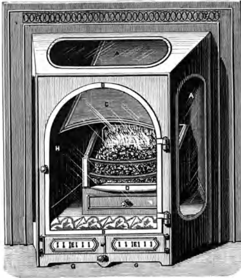
Kaminofen und Schirm für Gasarme etc. zur gleichzeitigen Heizung, Beleuchtung und Ventilation.
