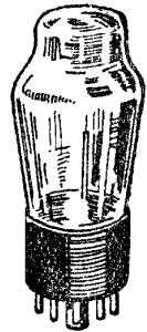
Пентод (антидинаatronная сетка соединена с катодом)
