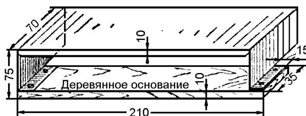
Фиг. 2. Шасси для выпрямителя.
