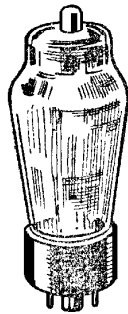
Двойной диод или двуханодный кенотрон с разделёнными катодами
