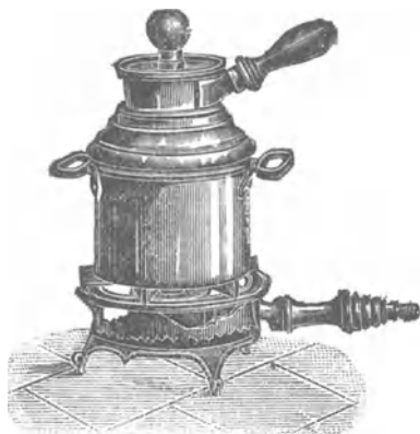
Abb. 49. Aufguß-(Infundier-)Apparat aus Kupfer ohne Lötung.
