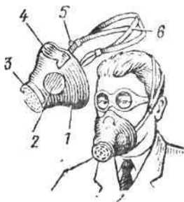
Рис. 15. Респиратор Р-2: 1 — полумаска; 2 — вдыхательный клапан; 3 — выдыхательный клапан; 4 — носовой зажим; 5 — тесемка; 6 — оголовок
