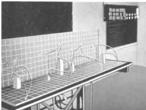
Abb. 193. Drahtmodelle der Zyklusgramme. (Nach ERMANSKI).
