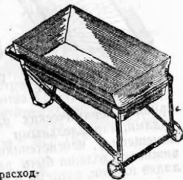
Рис. 38. Приспособление для резки плиток по диагонали
