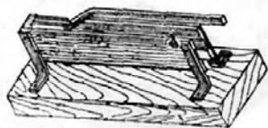
Рис. 43. Приспособление для резки плиток
