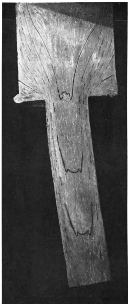
Abb. 43. Messing. Öffnung: 50 mm \varnothing . Preßstufe 3. (Zyl. \varnothing 110 mm. Preßtemp. 650°.)
