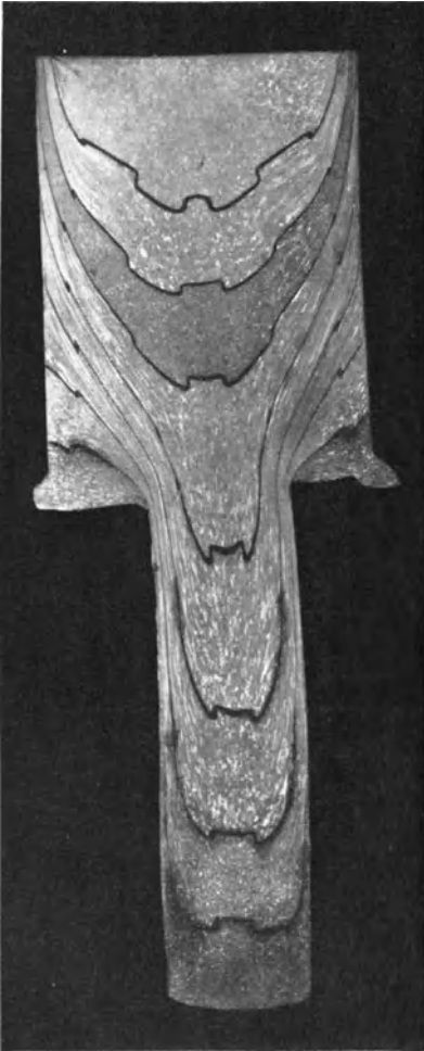
Abb. 39. Aluminium. Öffnung: 50 mm \varnothing . Preßstufe 1. (Zyl. \varnothing 110 mm. Preßtemp. 420°.)
