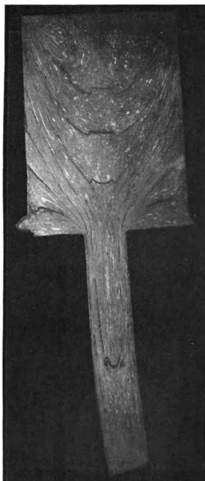
Abb. 44. Messing. Öffnung: 30 mm \varnothing . Preßstufe 1. (Zyl. \varnothing 110 mm. Preßtemp. 650°.)
