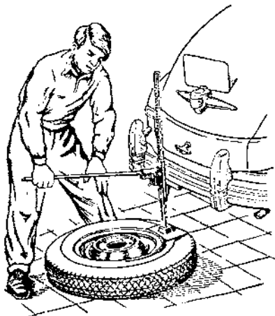
Фиг. 17 Отделение покрышки от обода колеса с помощью домкрата.
