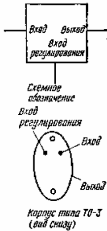
Рис. П.2.33. Интегральная схема типа LM317 регулируемого стабилизатора напряжения.
