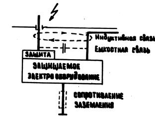
Рис.2.4. Три возможных варианта электромагнитных связей при некорректной установке элементов защиты
