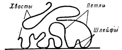
Рис. II.1. Схематическое изображение макромолекулы, адсорбированной на плоской поверхности.
