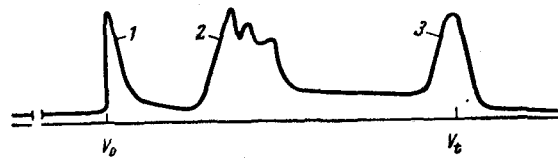
Рис. IV.10. Хроматограмма полидисперсного полимера: 1 — фракция, выходящая с исключенным объемом V_0 ; 2 — фракция, выходящая с полным объемом V_t ; 3 — фракция, разрешаемая при ГПХ.
