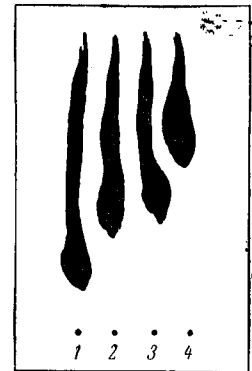
Рис. VIII.18. Форма хроматографического пятна образцов полистирола ( M_w = 8,7 \times 10^5 ) в бензоле на силикагеле КСК:
