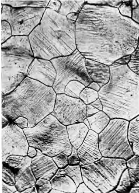
Abb. 75. Gleitlinien auf der Oberfläche von verformtem Eisen. (Nach EWING und ROSENHAIN.)
