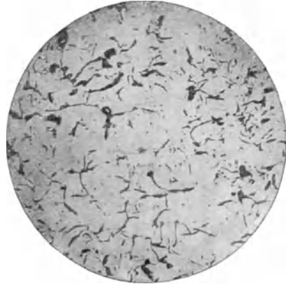
Abb. 62. Graues Gußeisen, ungeätzt. Vergr. 75 \times . (Aus E. PREUSS, Die praktische Nutzenanwendung der Prüfung mit Hilfe des Mikroskopes.)
