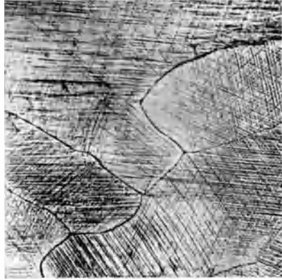
Abb. 72. Gleitlinien auf der Oberfläche von verformtem Blei. Vergr. 100×. (Nach EWING und ROSENHAIN.)
