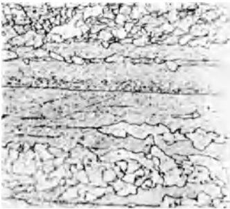
Abb. 101. Fortschreitende Rekristallisation in einer Kupfer-Nickel-Legierung nach Erhitzung auf 520°. Vergr. 350×. (Nach ADCOCK.)
