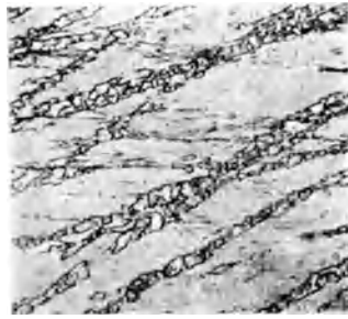
Abb. 100. Gewalzte Kupfer-Nickel-Legierung nach Erhitzung auf 490—500°. Vergr. 350×. (Nach ADCOCK.)
