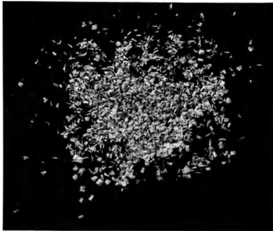
Abb. 51 b. Ein kurzer Span des „Automatenzinks“, hergestellt durch Zusatz von Blei und Wismut zur Legierung Abb. 51 a. (Aus P. BURKHARDT, Technologie der Zinklegierungen.)
