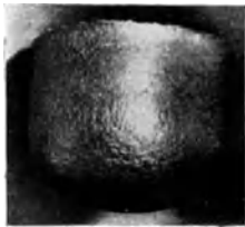
Abb. 109. Grobkörniges Metall, das nach dem Näpfchenziehen narbig geworden ist.
