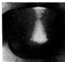
Abb. 110. Feinkörniges Metall, das beim Tiefziehen glatt bleibt.
