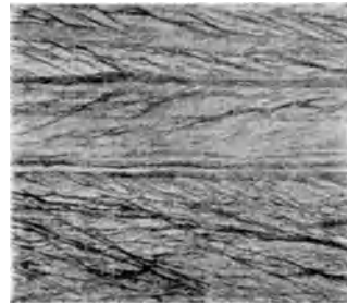
Abb. 98. Struktur einer kaltgereckten Kupfer-Nickel-Legierung. Vergr. 100 \times . (Nach ADCOCK.)
