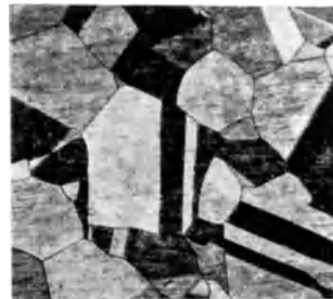
Abb. 104. Kornwachstum mit Zwillingsbildung in einer Kupfer-Nickel-Legierung nach Erhitzung auf 960—980°. Vergr. 100×. (Nach ADCOCK.)
