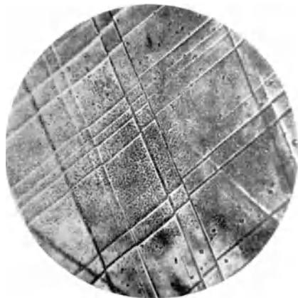
Abb. 73. Gleitlinien auf der Oberfläche eines Bleikristalles als Stufen. Vergr. 1000×. (Nach EWING und ROSENHAIN.)
