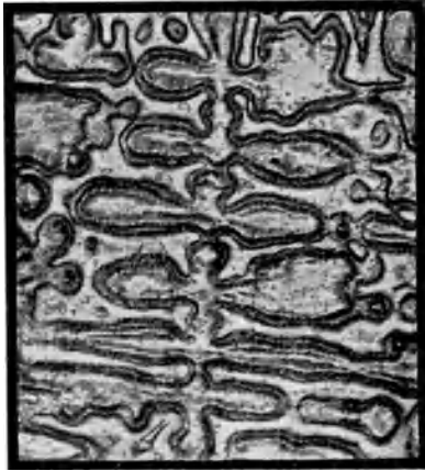
Abb. 36. Umhüllungen in einer Cu-Si-Legierung mit 4,9% Si. Vergr. 60×. (Aus GUERTLER, Metallographie.)
