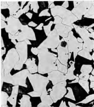
Abb. 58. Mikrostruktur eines Stahles mit 0,26% C (Ferrit und Perlit). Vergr. 100 \times . (Aus P. OBERHOFFER, Das technische Eisen.)
