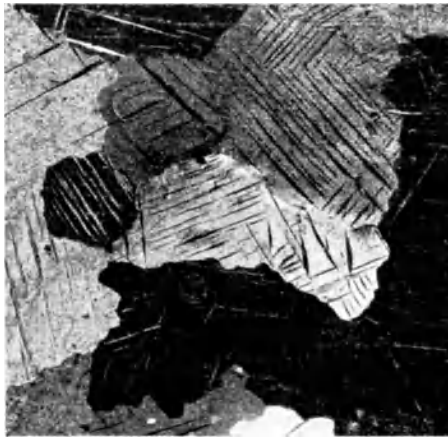
Abb. 85. Zwillinge in einer gebogenen Zink-Lamelle. Vergr. 12 \times .
