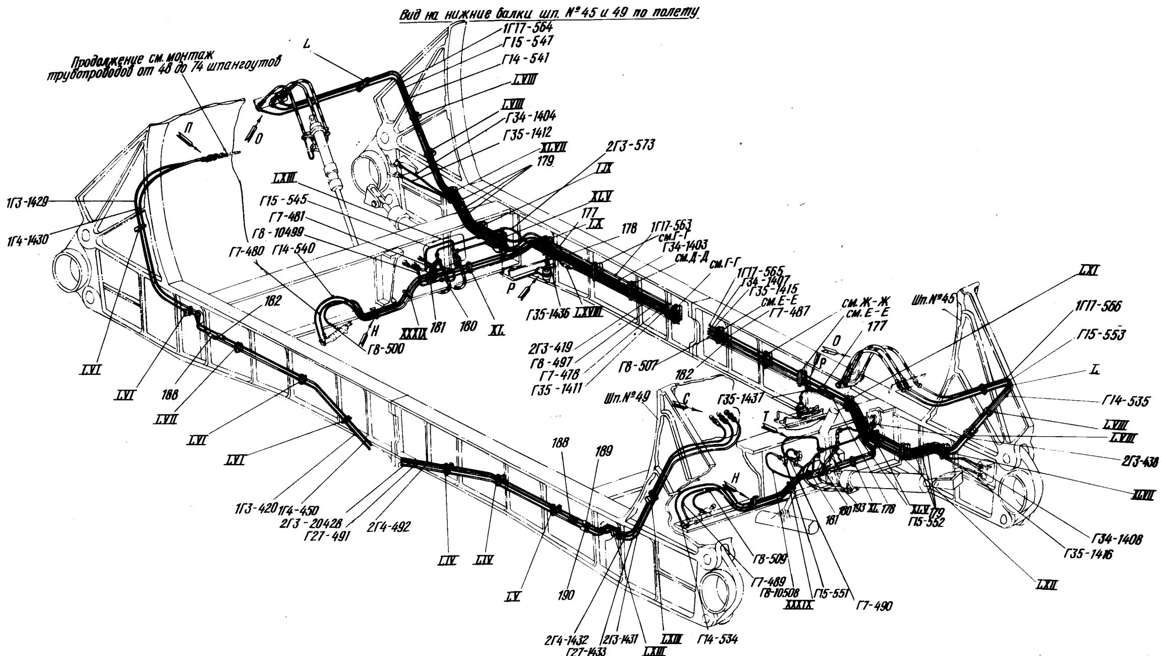
Гидросистема в отсеке главного шасси
