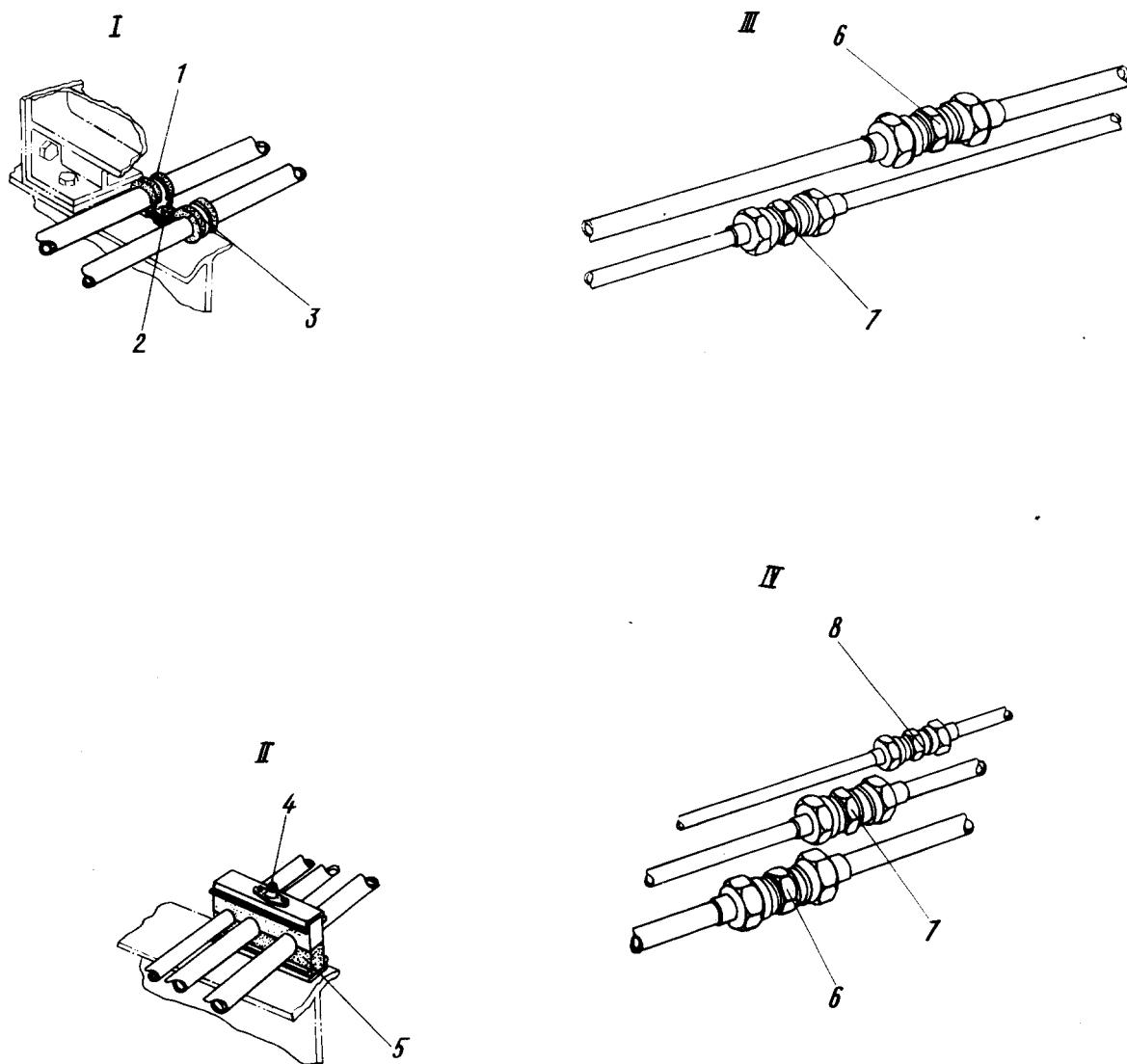
Трубопроводы в фюзеляже между шпангоутами № 18 и 35
