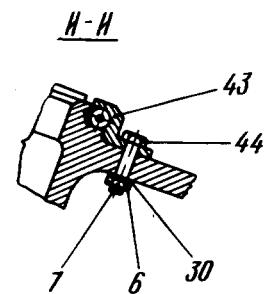
Управление поворотом колес носовой ноги шасси
