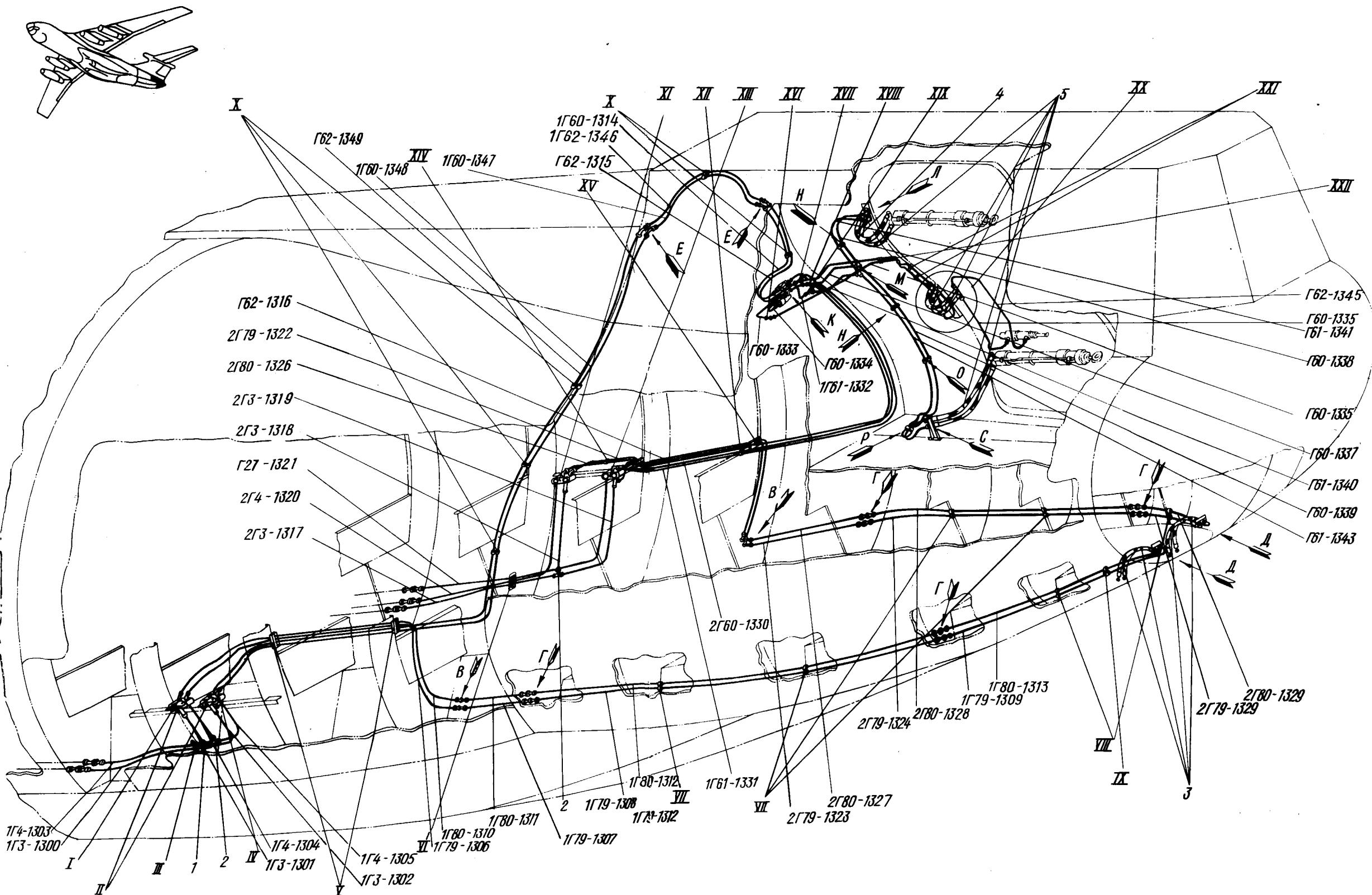
Гидросистема в хвостовой части фюзеляжа
