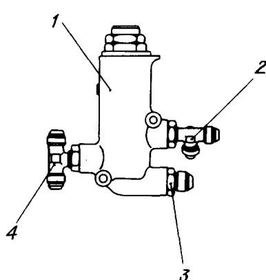
Панель агрегатов стояночного торможения
