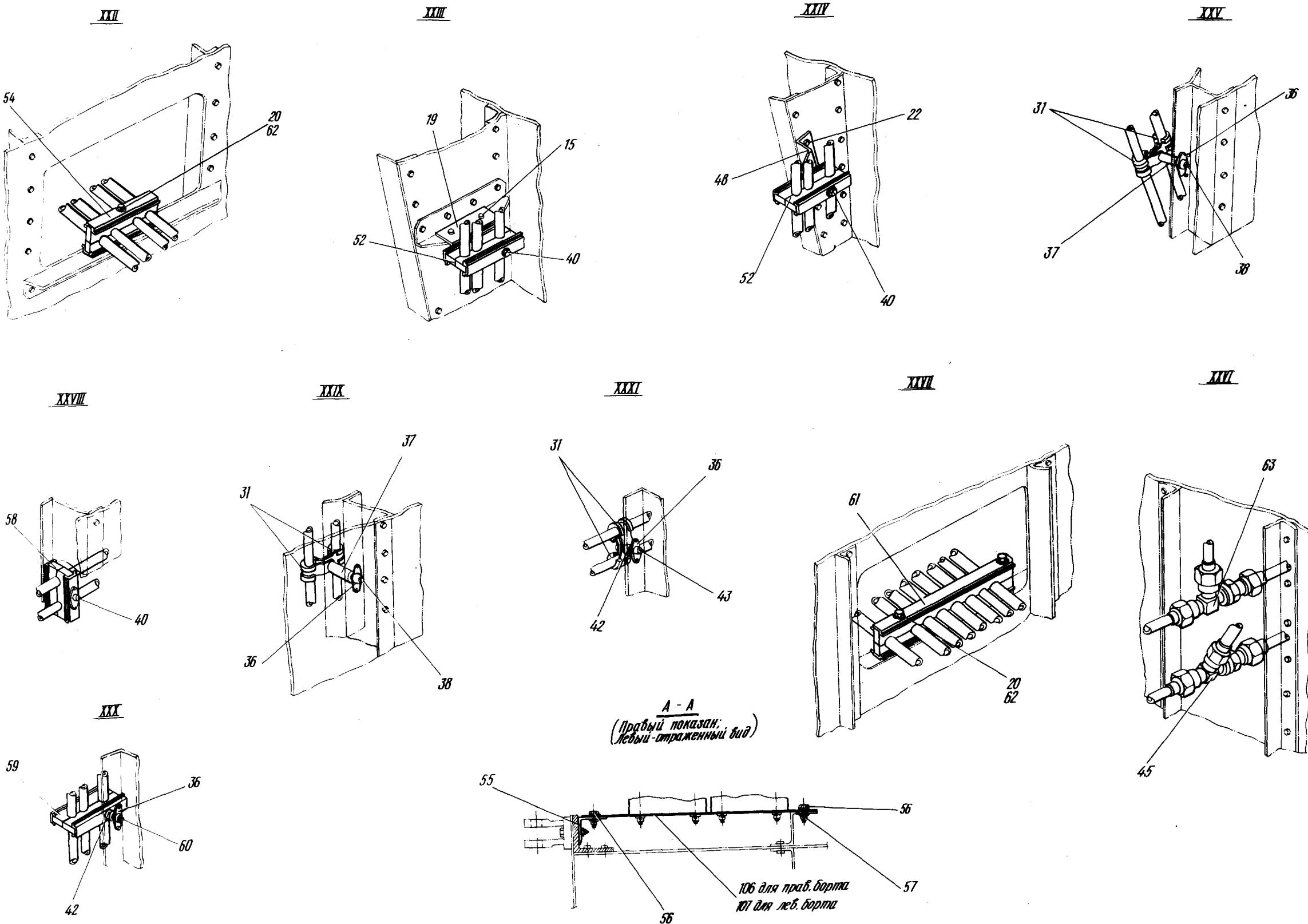
Гидросистема в отсеке носовой ноги шасси
