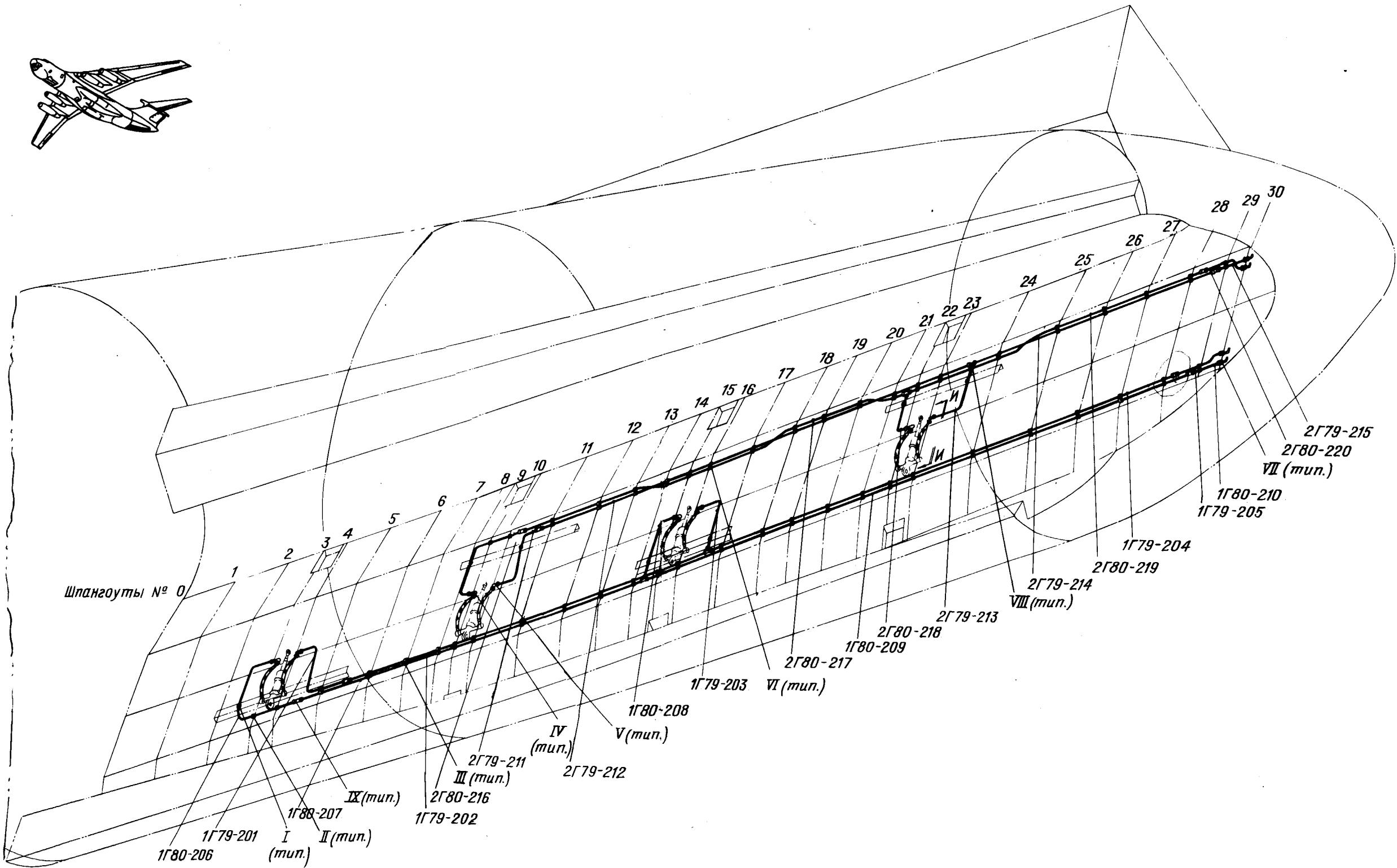
Трубопроводы на средней створке грузового отсека
