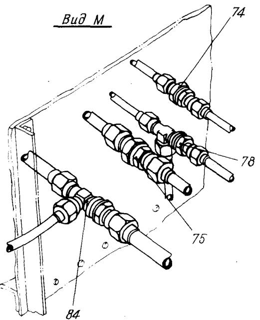
Гидросистема в отсеке главного шасси
