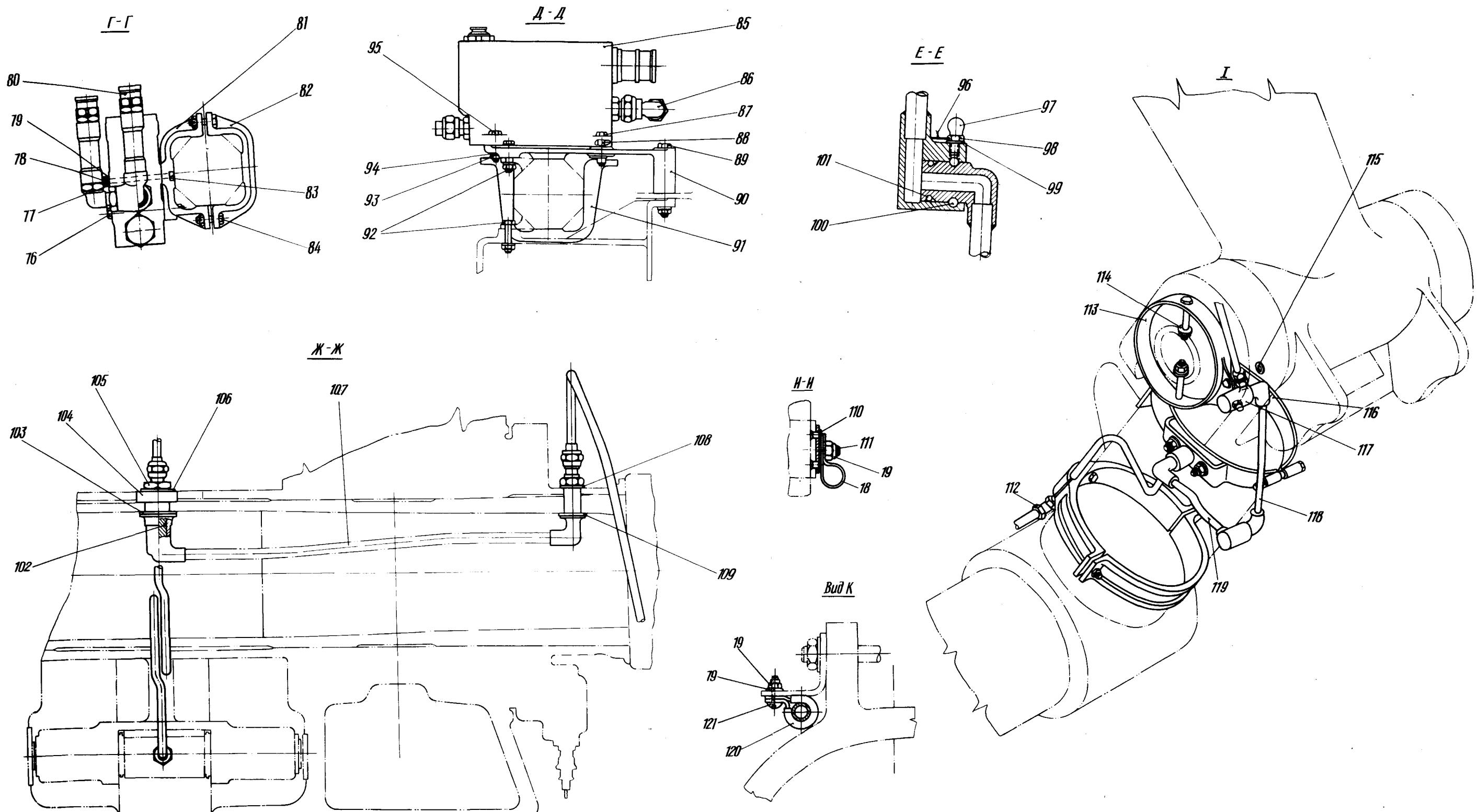
Проводка трубопроводов к цилиндуру поворота носового шасси
