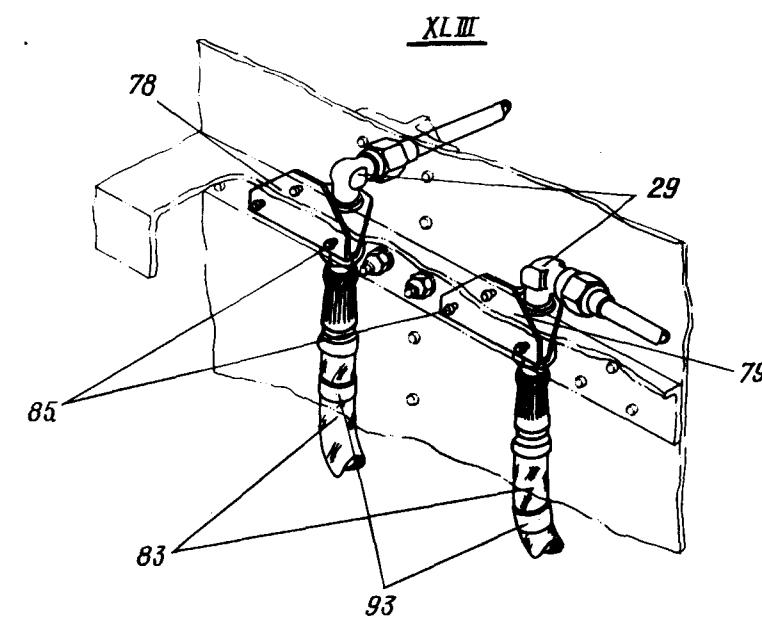
Гидросистема в отсеке носовой ноги шасси
