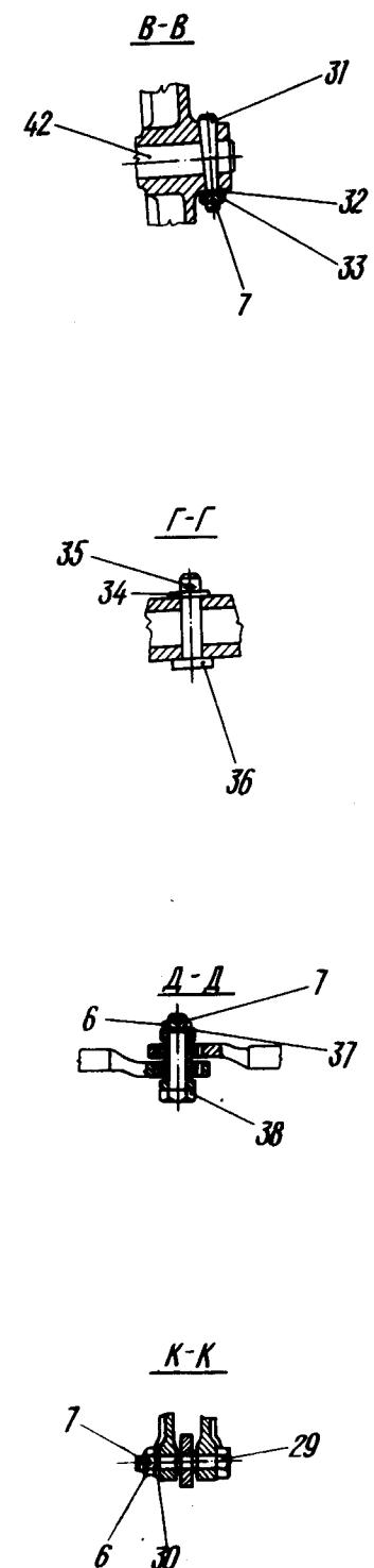
Управление поворотом колес носовой ноги шасси
