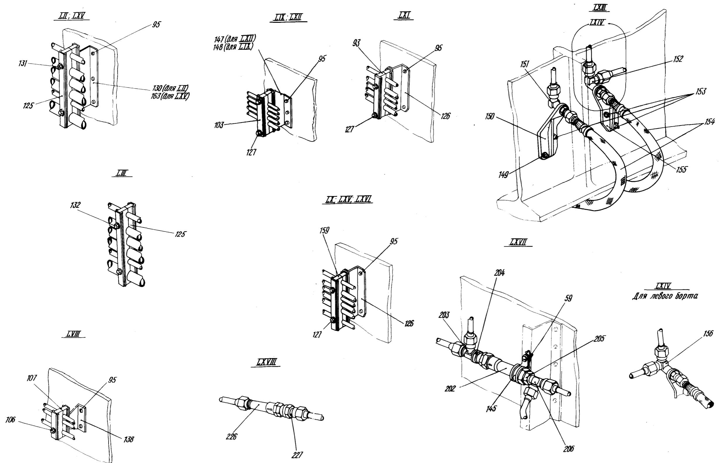
Гидросистема в отсеке главного шасси
