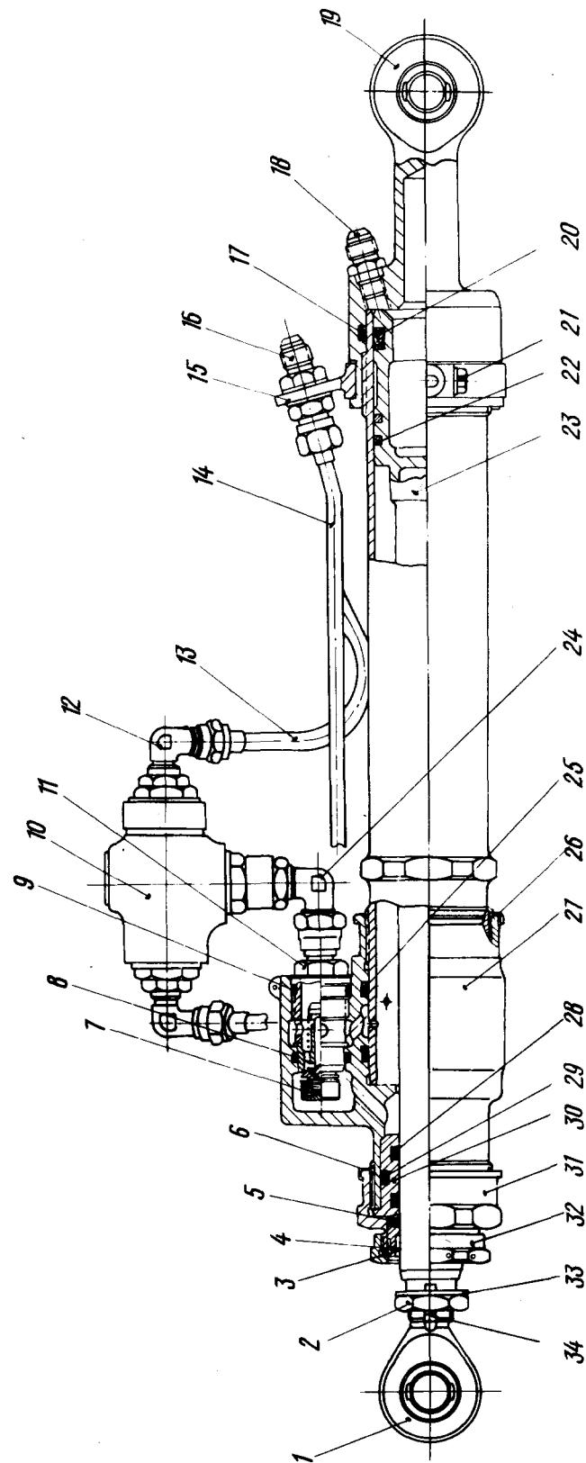
Гидроцилиндр больших створок отсека главной ноги шасси
