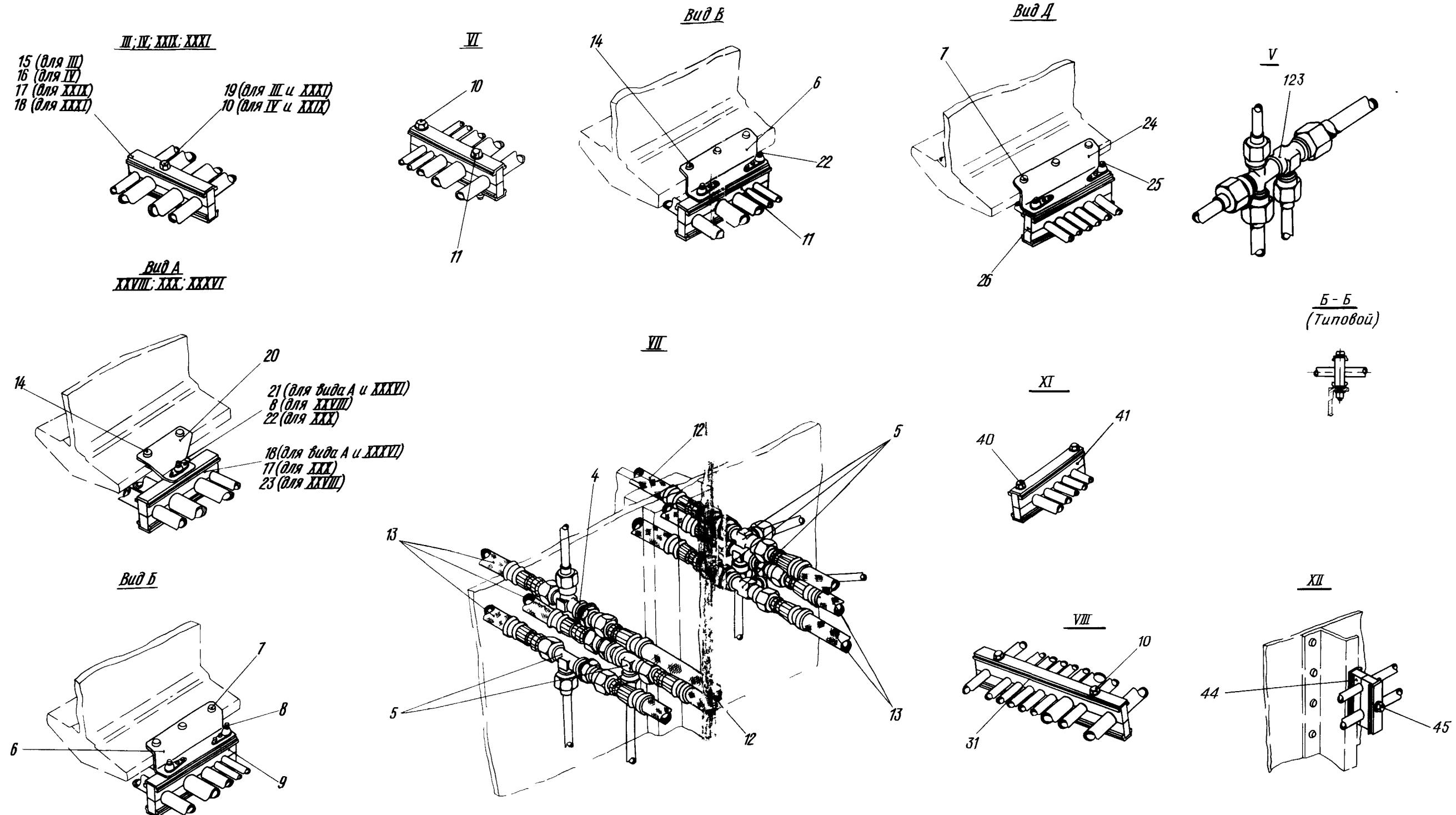
Гидросистема в отсеке главного шасси
