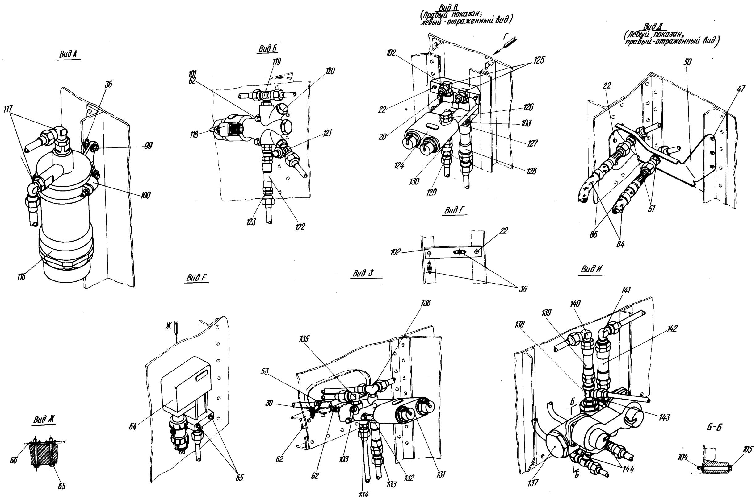
Гидросистема в отсеке носовой ноги шасси
