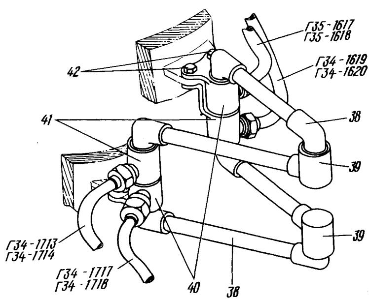
Типовая сборка шарнира
