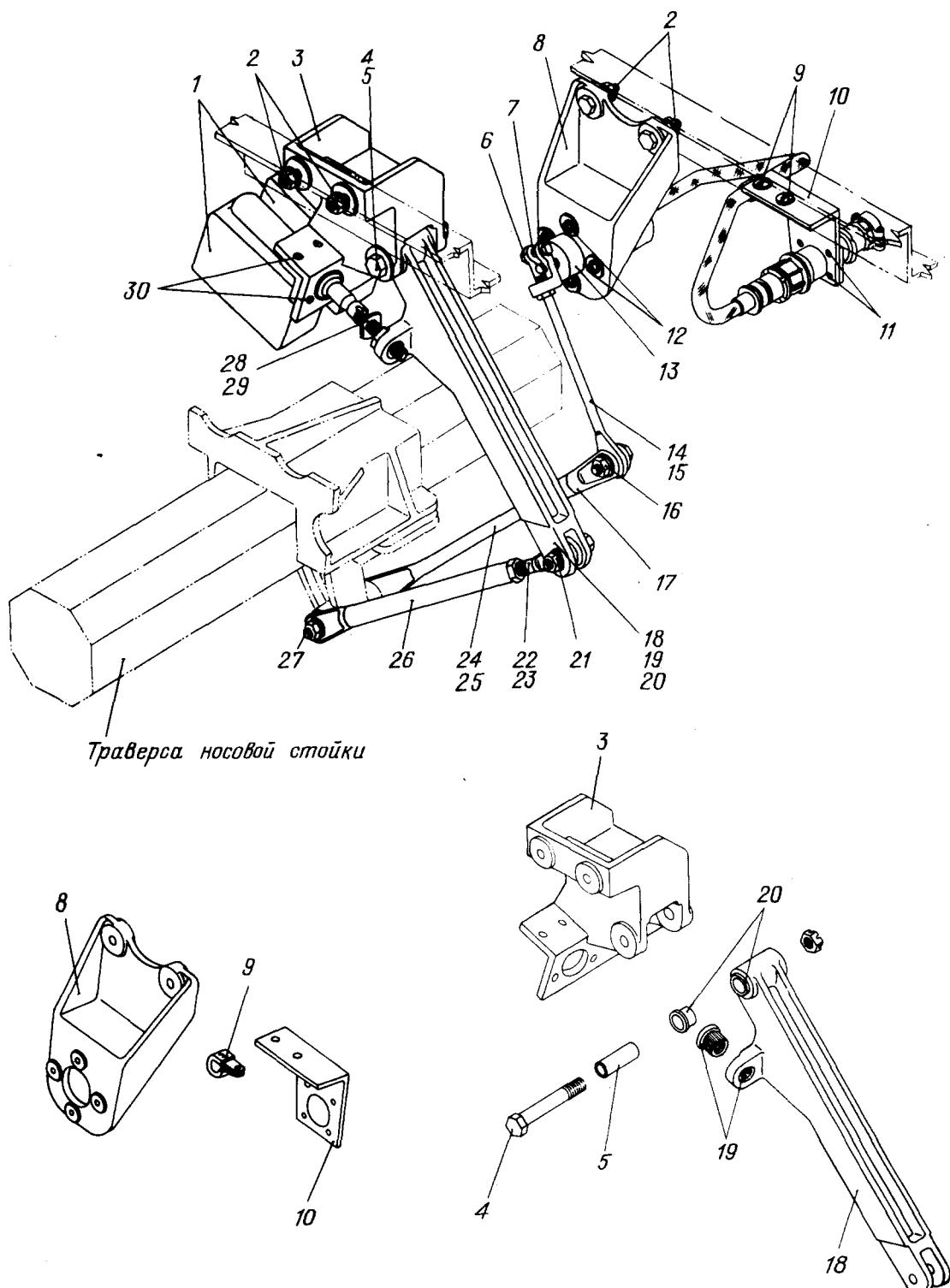
Датчик ДС-10 и концевые выключатели носовой ноги шасси
