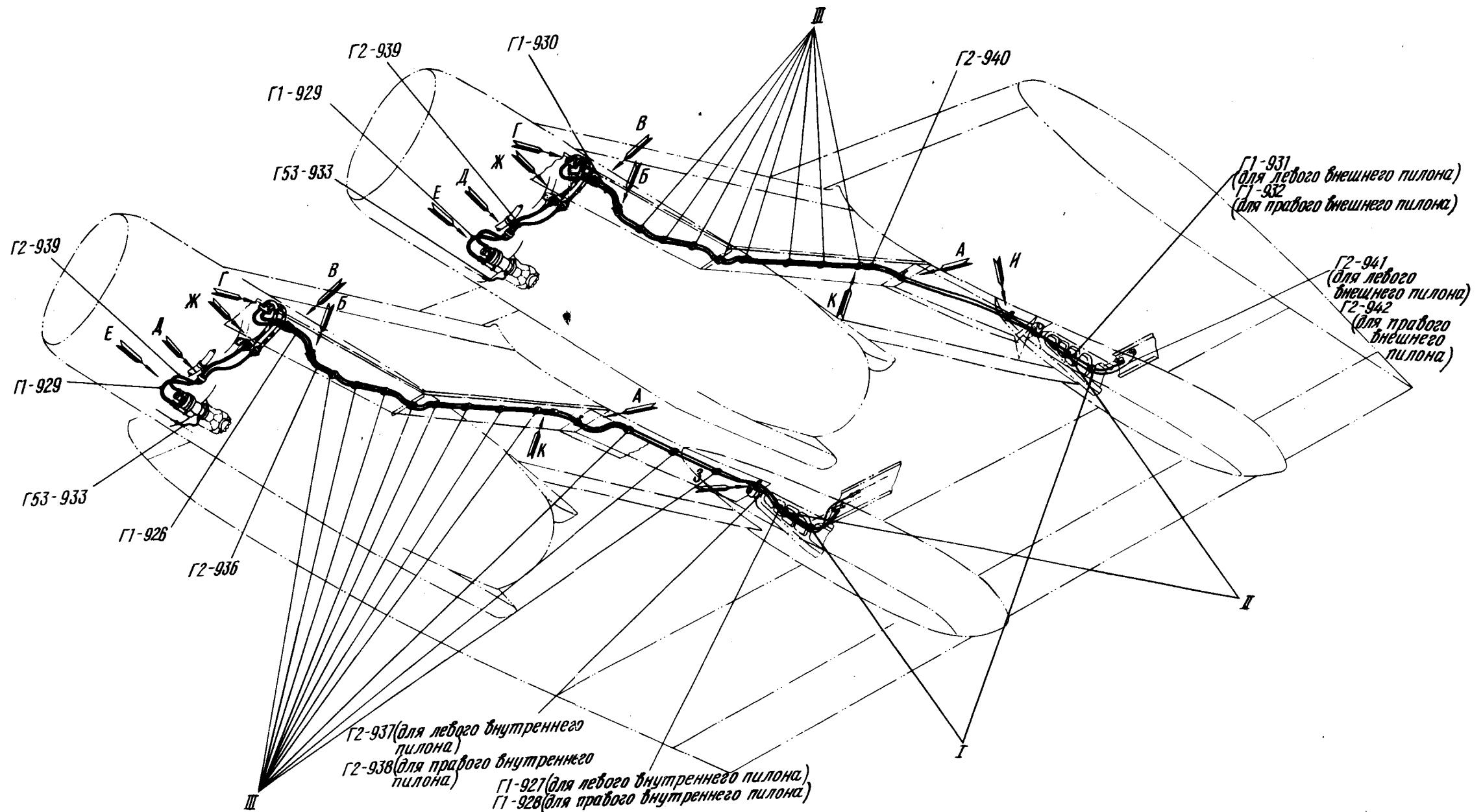
Гидросистема в пилонах с гидронасосом НП-89Д
