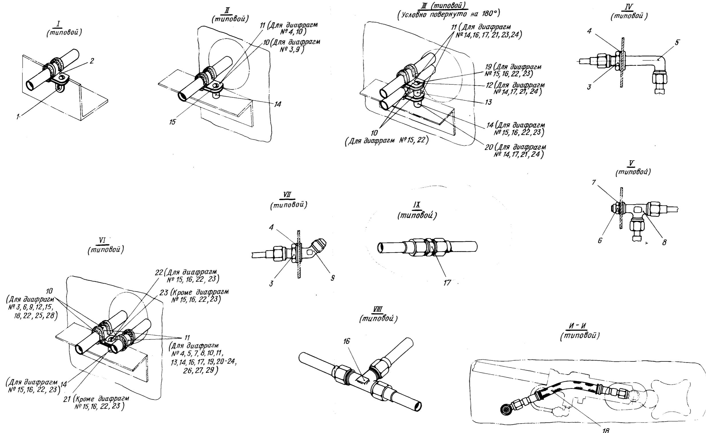
Трубопроводы на средней створке грузового отсека
