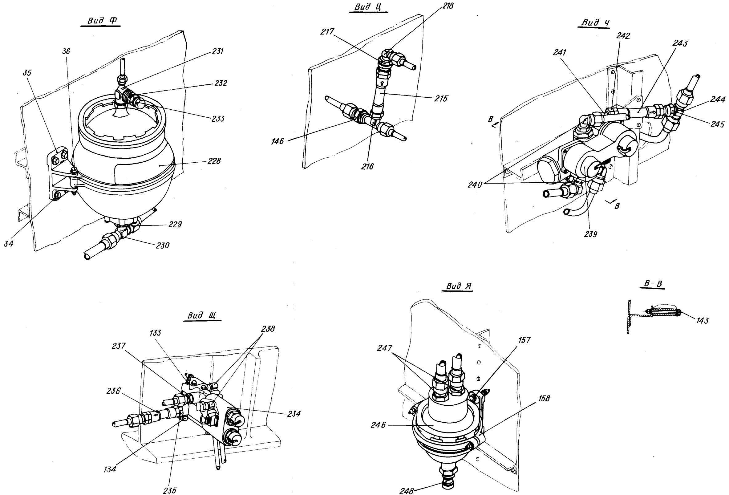
Гидросистема в отсеке главного шасси
