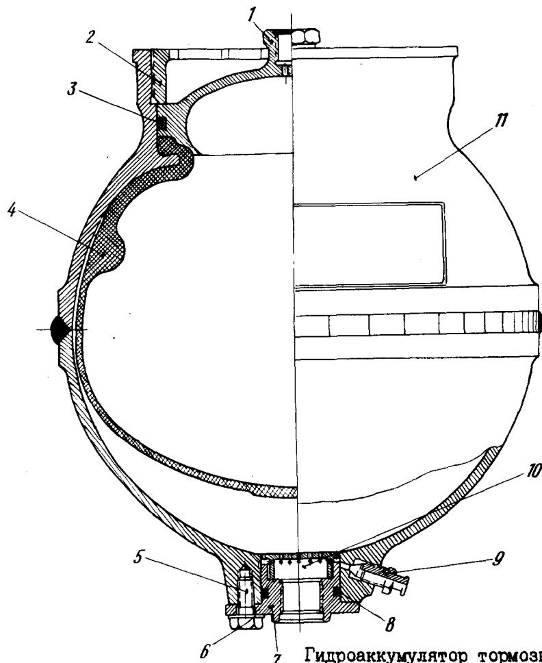
Гидроаккумулятор тормозной системы
