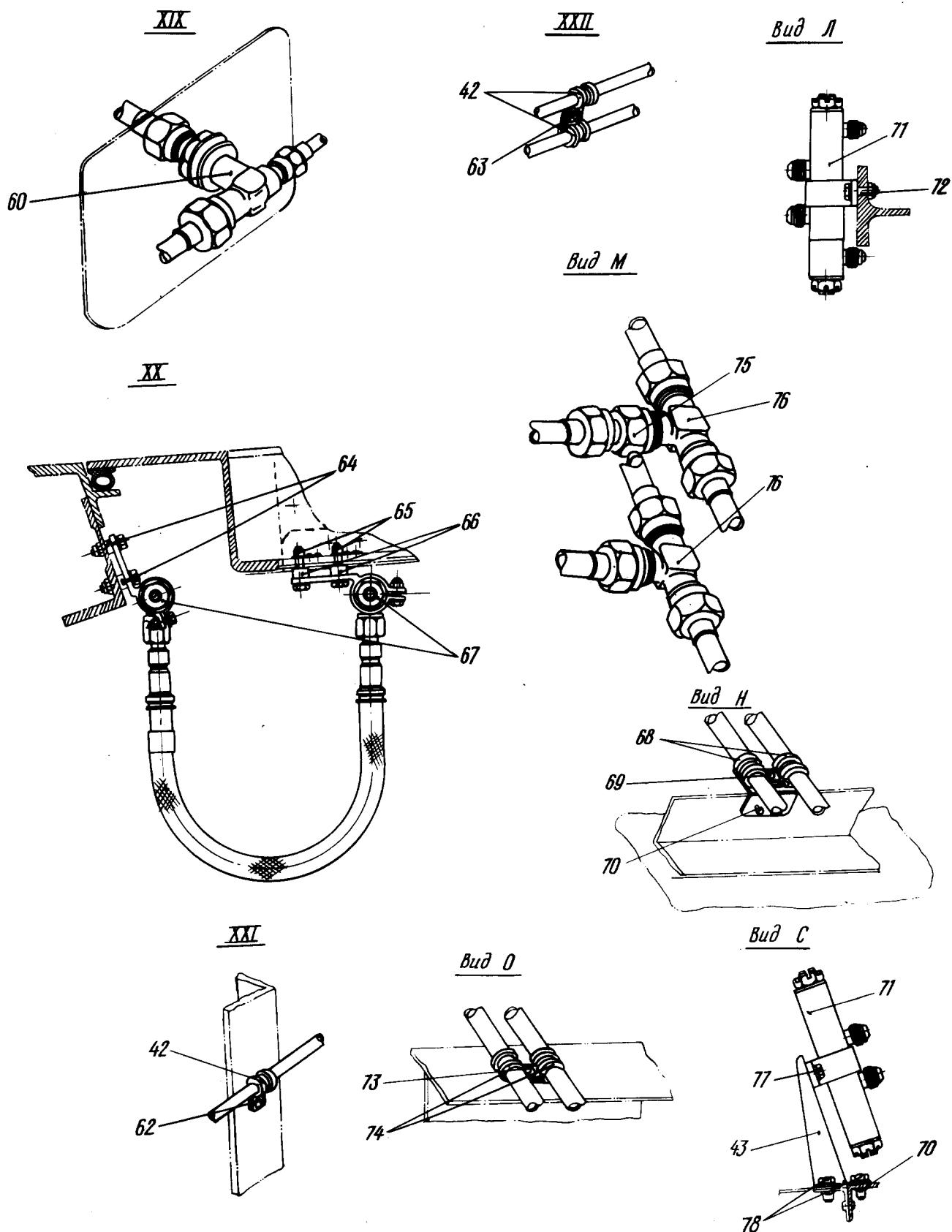
Гидросистема в хвостовой части фюзеляжа
