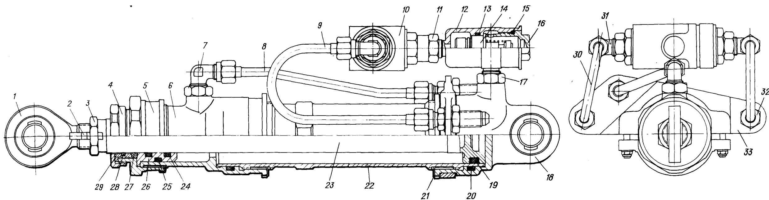
Гидроцилиндр складывающегося подкоса
