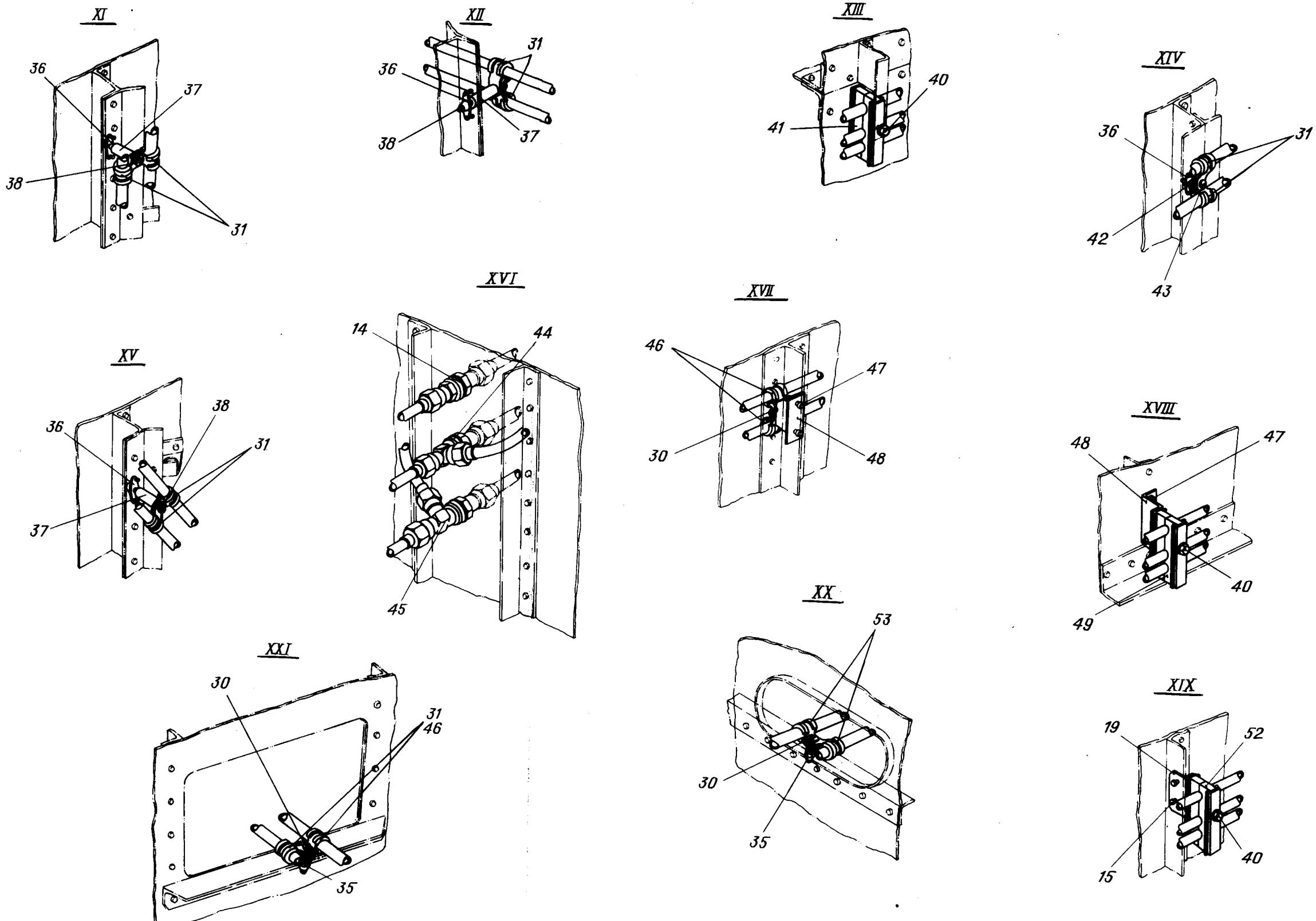
Гидросистема в отсеке носовой ноги шасси
