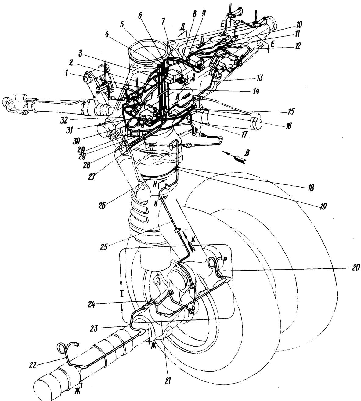
Проводка трубопроводов к цилиндру поворота носового шасси
