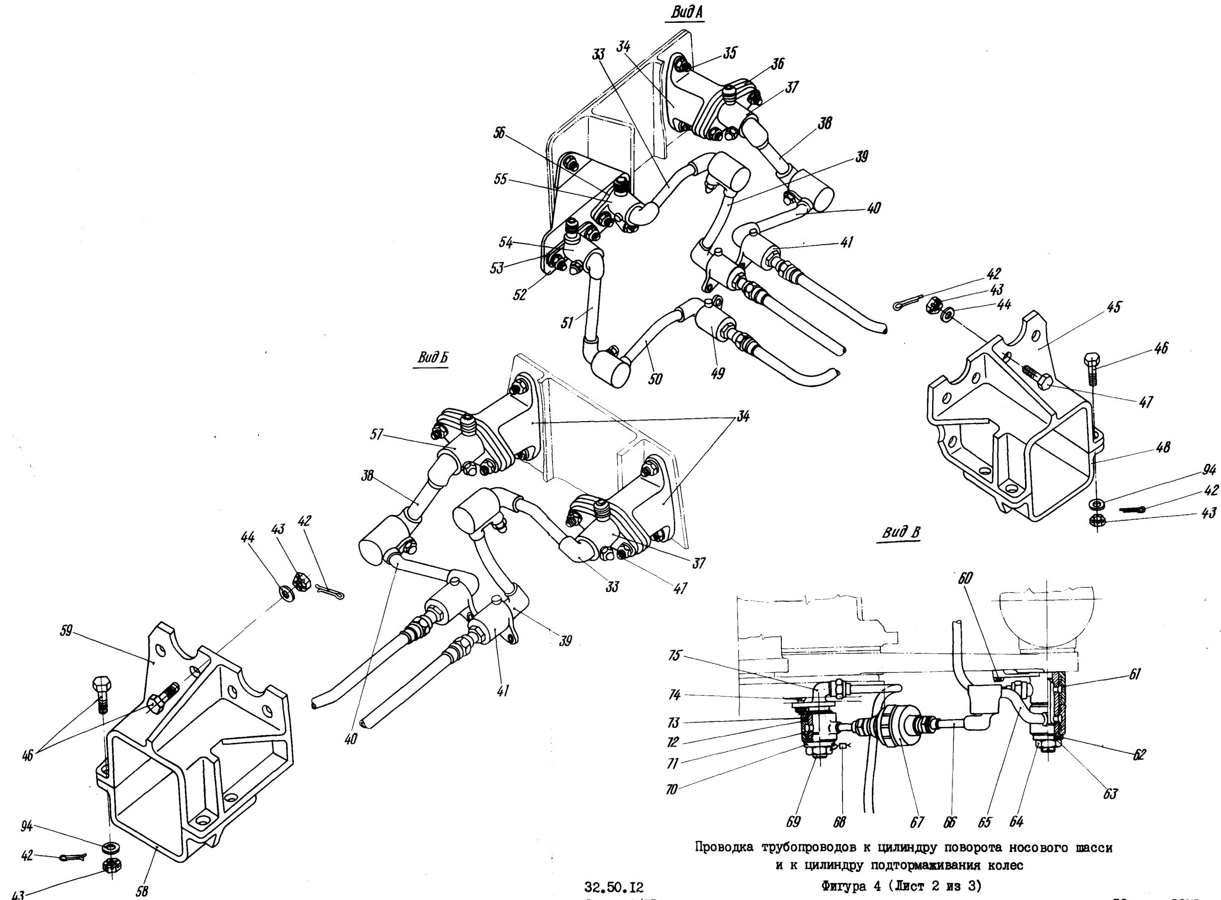
Проводка трубопроводов к цилиндуру поворота носового шасси и к цилиндуру подтормаживания колес
