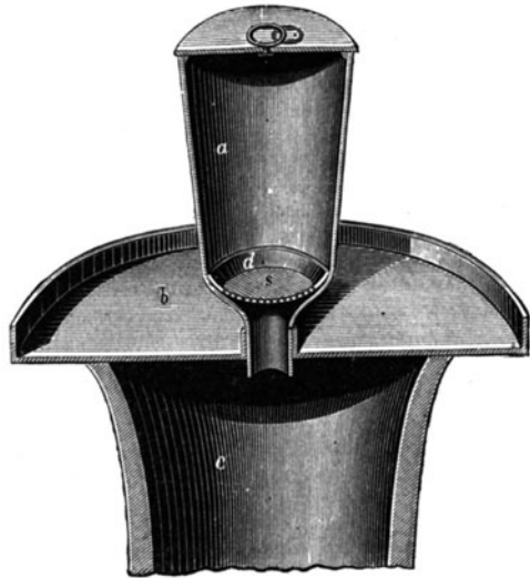
Fig. 225. Vorrichtung zur Bereitung von Kopalack im Längsschnitt.
