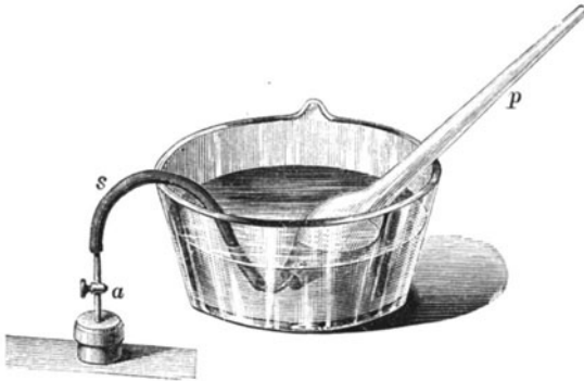
Fig. 98. p Aërodecker-Rohr. a Abblaserrohr mit Hahn auf dem Mischgefäß. s Gummischlauch mit gekrümmtem Glasrohransatz.
