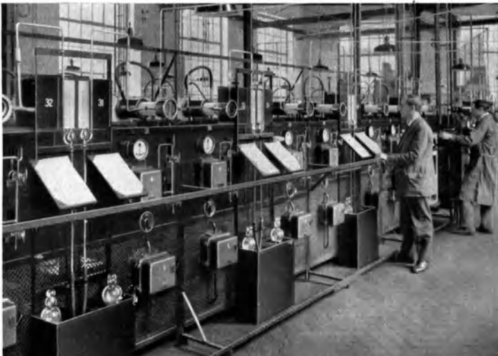
Abb. 127. Ofenbatterie für Vakuumvorentgasung (Siemens-Röhren-Werk).
