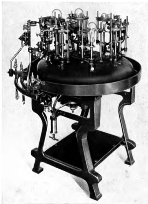
Abb. 190. Kolbeneinschmelzmaschine mit 8 Zangen (Hersteller: Gladitz G. m. b. H.).
