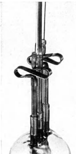
Abb. 278. Zugfeder aus 3 mm breitem Tantalblech mit parallel geschaltetem Kupferband für Stromdurchgang (vgl. Abb. 277, Teilbild 6).
