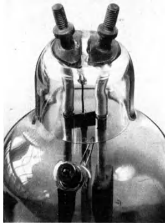
Abb. 384. Cr-Fe-Doppelscheibeneinschmelzung für Anodenzuleitungen eines Glühkathodengleichrichters (Hersteller: Philips).
