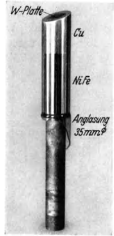
Abb. 382. Röntgenanode mit Ni-Fe-Schaft und angeschmolzenem Glasrohr (Hersteller: Deutsche Glühfaden-Fabrik).
