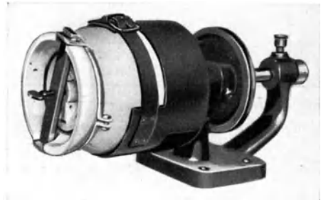
Abb. 294. Kugelmühle (Inhalt 1 bis 2,5 l) zum Feinmahlen der Oxydpaste (Hersteller: Gladitz, Berlin).
