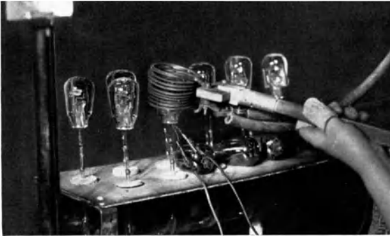
Abb. 138. Entgasung und Getterung von Rundfunkröhren durch Hochfrequenzspulen (Fabrikation Telefunken-Osram).
