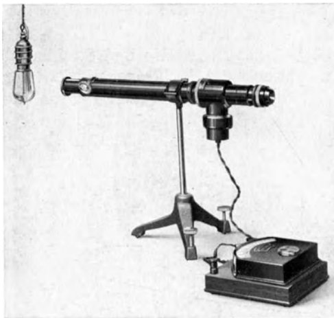
Abb. 133. Mikropyrometer mit Anzeigeinstrument, geeicht am Schwarzen Körper mit Filter für \lambda = 0,650 \mu (Hersteller: Siemens & Halske).
