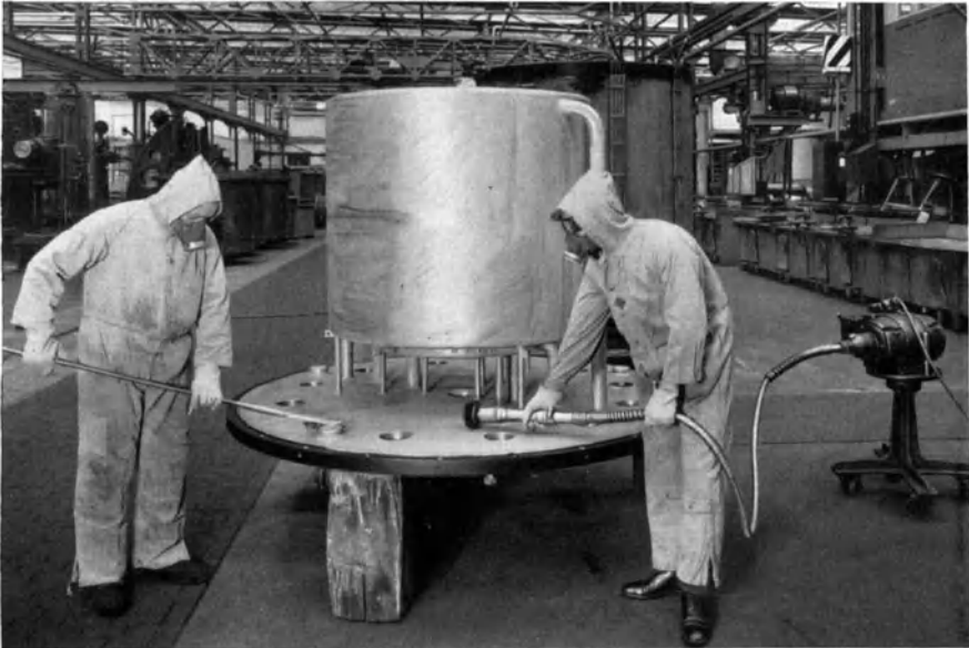
Abb. 164. Oberflächenreinigung eines Großgleichrichters durch Drahtbürsten (aus der Fabrikation Siemens-Röhrenwerk; über hygienische Schutzmaßnahmen vgl. Abschnitt 7, S. 102).
