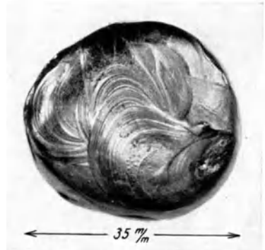
Abb. 36. Im Lichtbogen geschmolzenes Ta (Hersteller: Siemens-Röhren-Werk).
