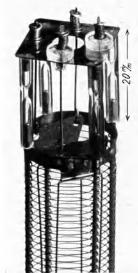
Abb. 279. Druckfeder aus Tantaldraht mit Quarzisolierung, montiert an der Gitterkrone einer Senderöhre (vgl. auch Abb. 211; Schema: Abb. 277, Teilbild 8).
