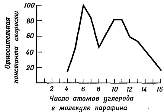
Рис. 12-3. Скорости гидрокрекинга нормальных парафинов на бифункциональном эрионитном катализаторе [17].
