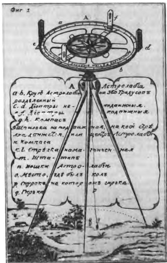
Рис. 5. Круглая астролябия со штативом работы русского инструментального мастера Ф. Тирутина (середина XVIII в.)
