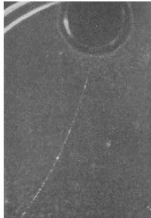
Abb. 48 a. Aussendung von Elektronen, Positronen und Protonen aus Al bei Bestrahlung mit  $\alpha$ -Teilchen.
