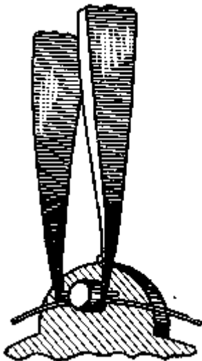
Рис. 73. Закрепление волоска в колодке
