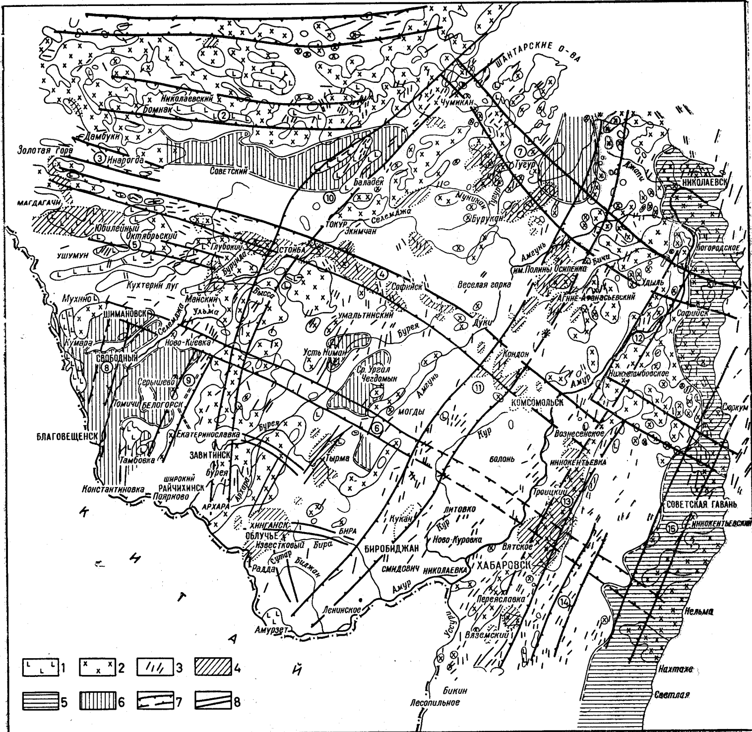
Рис. 105. Схема интерпретации аэромагнитной съемки южной части Хабаровского края и Амурской области и предполагаемые главные зоны разломов
