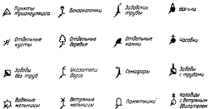
Рис. 8. Положение местных предметов, изображаемых внемасштабными условными знаками
