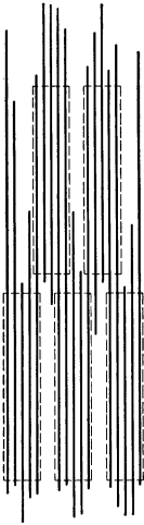
Abb. 47. Schematische Darstellung des möglichen Übergreifens von Hauptvalenzketten in andere Gitterbereiche. — Hauptvalenzketten; - - - - ungestörte Gitterbereiche.
