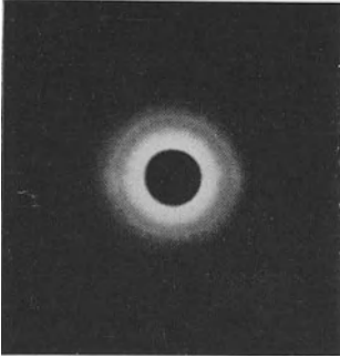
Abb. 59. Röntgendiagramm von Epidermisstreifen der Avena -Koleoptile (nach HEYN, 4). Man erkennt den Richtungseffekt der Micelle an der äquatorialen Verbreiterung des Interferenzkreises. (Im Gegensatz zu Abb. 2 ist hier das Positiv der Röntgenaufnahme reproduziert.)
