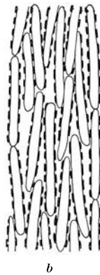
Abb. 31. Faserdichroismus. a) Schematische Darstellung der Ag-Einlagerung. b) Schematische Darstellung der J-Einlagerung. NB. Die aufgenommenen Farbstoffmengen sind sehr viel kleiner als in diesem Schema angegeben ist. Die eingelagerte Ag-Menge beträgt z. B. nur 1-4,7 Gew.-% (KOLBE).
