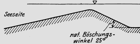
Abb. 246. Sandriff. Sanfte Neigung nach der See, unter natürlichem Böschungswinkel nach Land zu.
