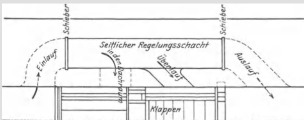
Abb. 368 a bis c. Hydraulisches Dachwehr. Höchste und Zwischenstellung. Grundriß.
