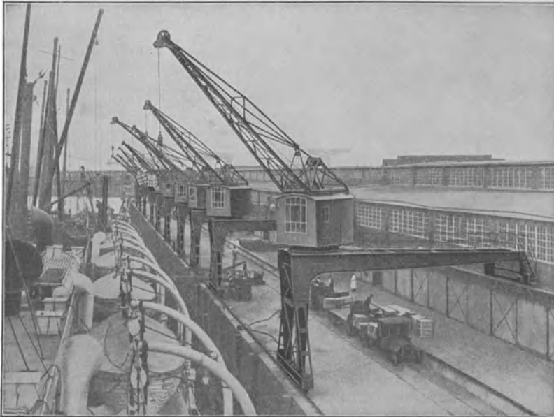
Abb. 825. Halbportalkrane Nagel & Kaemp.
