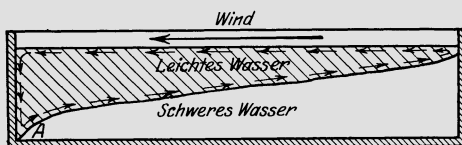
Abb. 67. Strömung durch Gewichtsungleichgewicht verschieden schweren Wassers.
