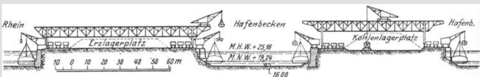
Abb. 1012 b. Querschnitt Rheinhafen Walsum. Maßstab 1 : 2300.
