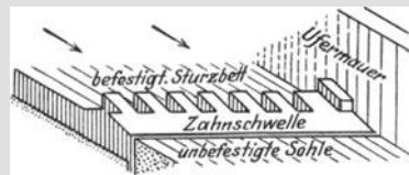
Abb. 322. Zahnleiste nach Rehbock.
