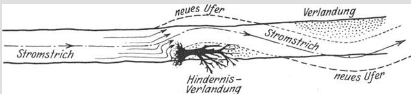
Abb. 12. Hindernis mit Laufverlegung eines Flusses.
