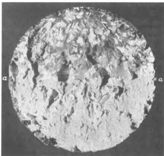
Abb. 71. Bronzestab. Oberhalb Linie a-a Schwingungsbruch; unterhalb Zerreibruch.
