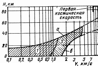
Рис. 1.4. Области применения летательных аппаратов с двигателями различных типов: 1—современные аппараты с ВРД; 2—перспективные аппараты с ВРД; а—ограничение по подъемной силе; б—ограничение по аэродинамическому нагреву
